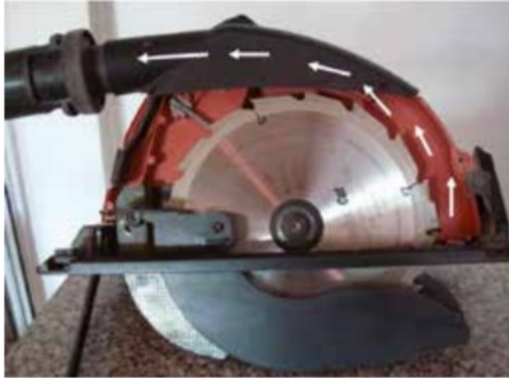
Kuva 5. Käsipyörösaha varustettuna kotelolla, joka ohjaa primääripölyn korkeapainellekohdepoistimelle (Welling et al. 2020, s. 25)
