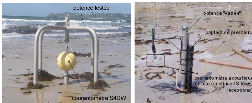
Illustration 98. Capteurs déployés sur les plages.
