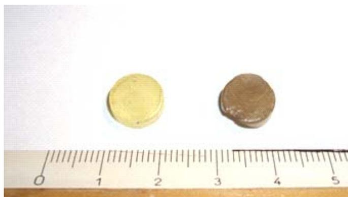
Fig. II.8 : Photographies d'électrolytes ( $\text{AgPO}_3\text{-AgI}$ ) synthétisés à un an d'intervalle.
