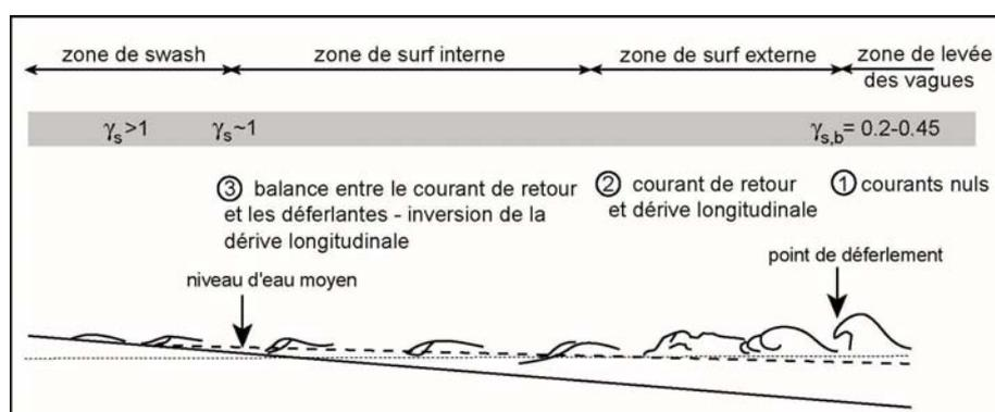
**Figure 5.** Evolution de la hauteur relative des vagues et type de courants induits lors de la transformation des vagues dans les petits fonds.
