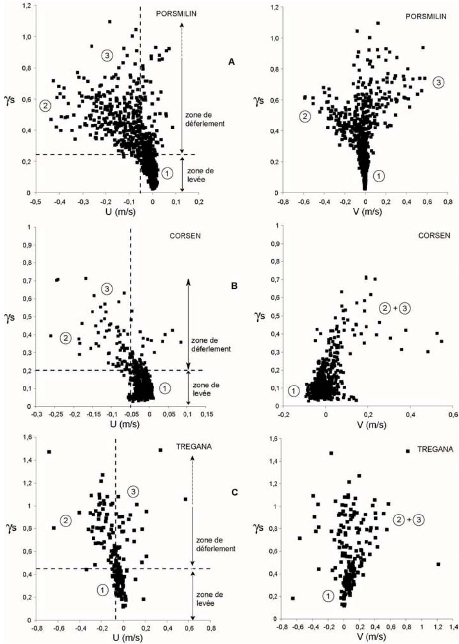
**Figure 4.** Courants cross-shore  $U$  ( $U > 0$  vers la plage,  $< 0$  vers le large) et longshore  $V$  fonction de la hauteur relative des vagues  $\gamma_s = H_s/h$  sur les plages de Porsmilin, Corsten et Tregana.
