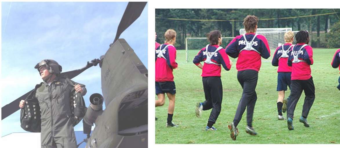
Figure 5. Exemples de gilets de stimulation vibro-tactiles. À gauche, un pilote d'hélicoptère portant un gilet vibro-tactile avec 12 colonnes et 5 lignes de vibreurs. À droite une photo avec les joueurs du club de football néerlandais du PSV Eindhoven. D'après Van Erp et al. (2006).
