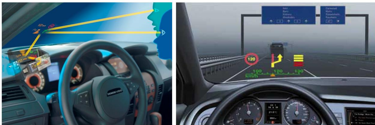
Figure 4. Les afficheurs tête haute : l'image de gauche en illustre le principe de fonctionnement et celle de droite donne un exemple dans une scène visuelle.
