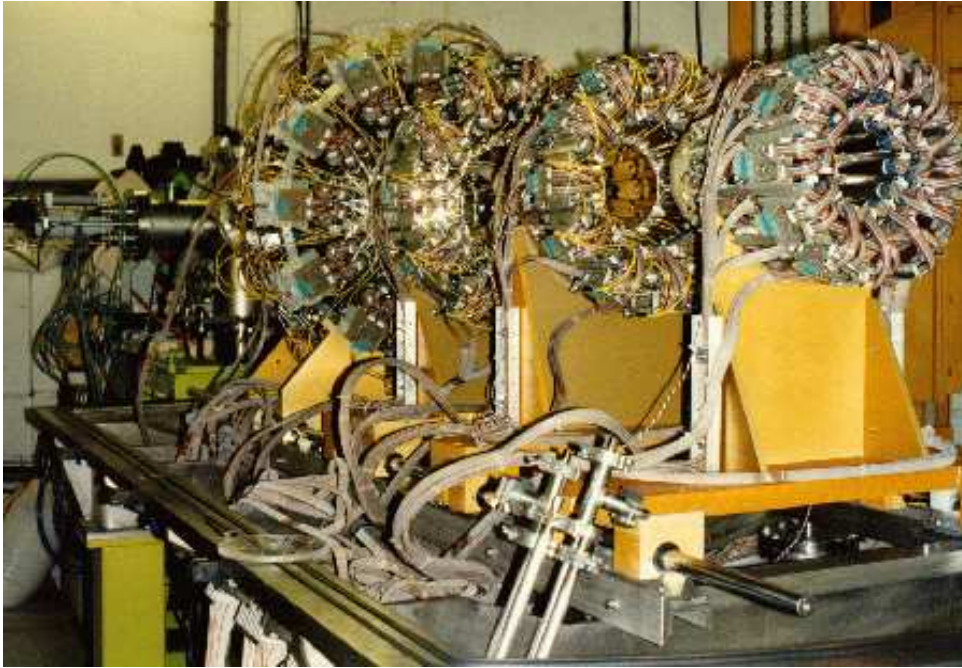
FIG. 3.4 – Photographie du détecteur 4\pi de particules chargées INDRA [INDRA 95].
