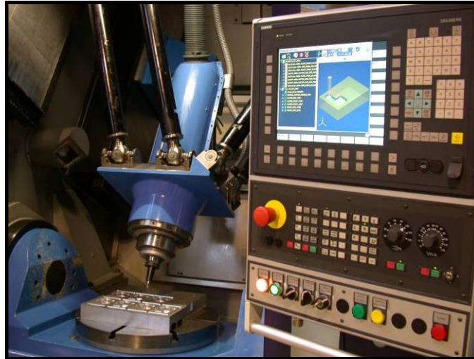
Figure 5 : Plate-forme SPAIM intégrée sur une Siemens 840D
