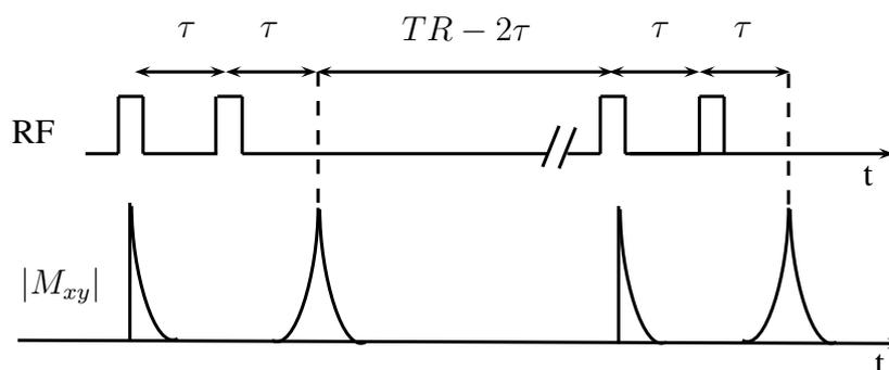
FIG. 2.5: Chronogramme de la RF pour une séquence SE et évolution temporelle du module de l'aimantation transversale.
