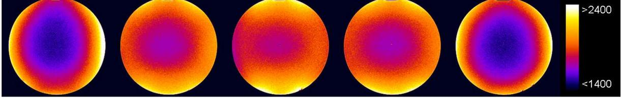
FIG. 2.10: Images d'un cylindre rempli d'huile, acquises de gauche à droite à  $-45$  mm,  $-22.5$  mm,  $0$  mm,  $22.5$  mm et  $45$  mm du centre de l'aimant. L'échelle des couleurs est représentée à droite. Les pixels d'intensité inférieure à  $1400$  sont représentés en noir, ceux d'intensité supérieure à  $2400$  en blanc.
