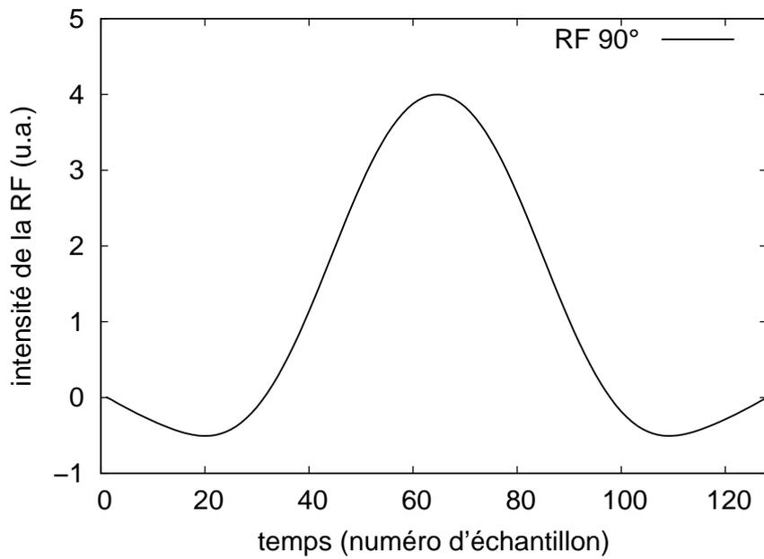
FIG. 2.11: Évolution temporelle de la RF pour l'application d'un angle de bascule de  $90^\circ$ .
