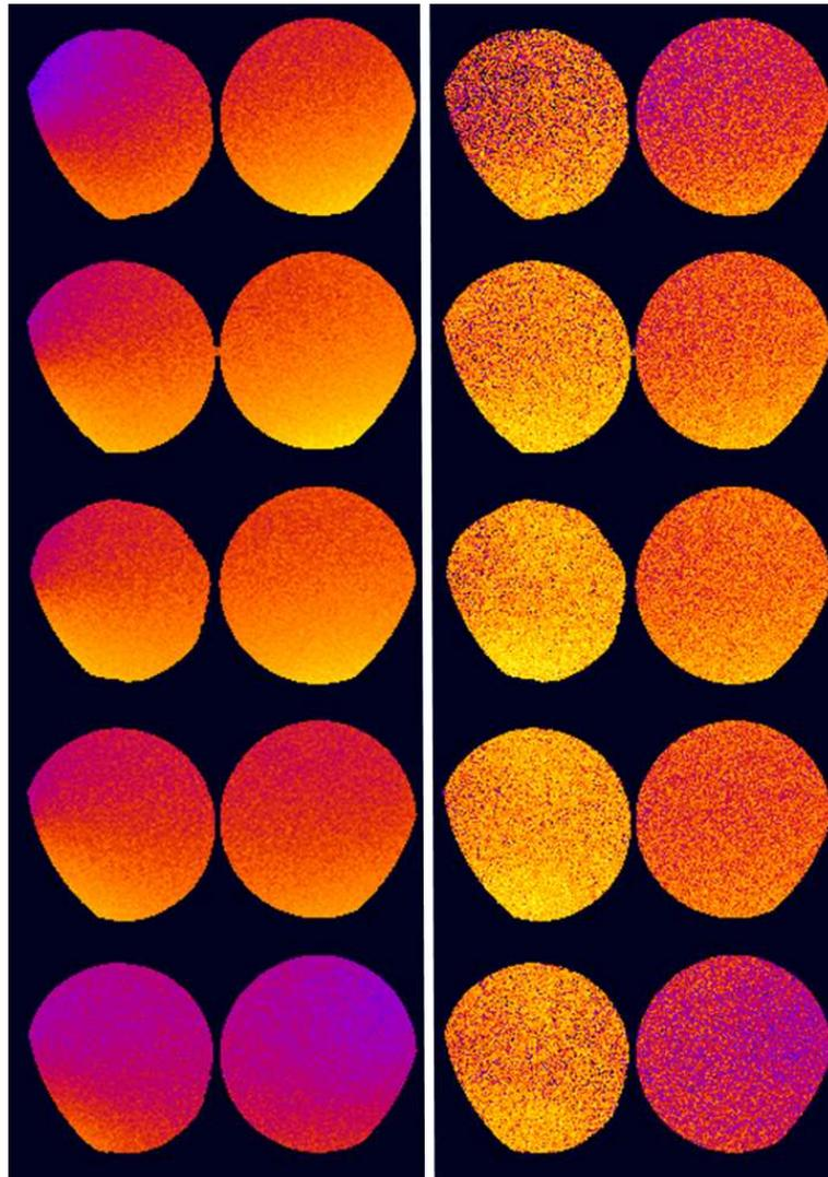
FIG. 5.18: Cartographies de  $\eta$  obtenues avec images de fantômes à gauche, sans images de fantômes à droite. Dans chacune des cartographies la partie de gauche correspond au cylindre d'eau dopée, celle de droite au cylindre d'huile.
