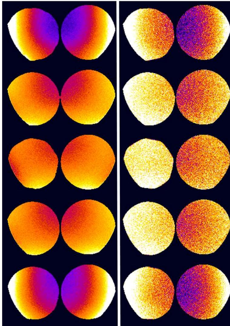
FIG. 5.17: Cartographies de  $R$  obtenues avec images de fantômes à gauche, sans images de fantômes à droite. Dans chacune des cartographies la partie de gauche correspond au cylindre d'eau dopée, celle de droite au cylindre d'huile.
