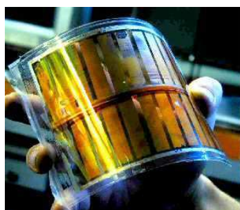
FIG. 1.15 – A gauche : cellule solaire à base d'un dérivé du PPV et de fullerène conçue par l'équipe de S. Sariciftci ; à droite : cellulaires solaires sous forme de rouleaux développées par la société Konarka.
