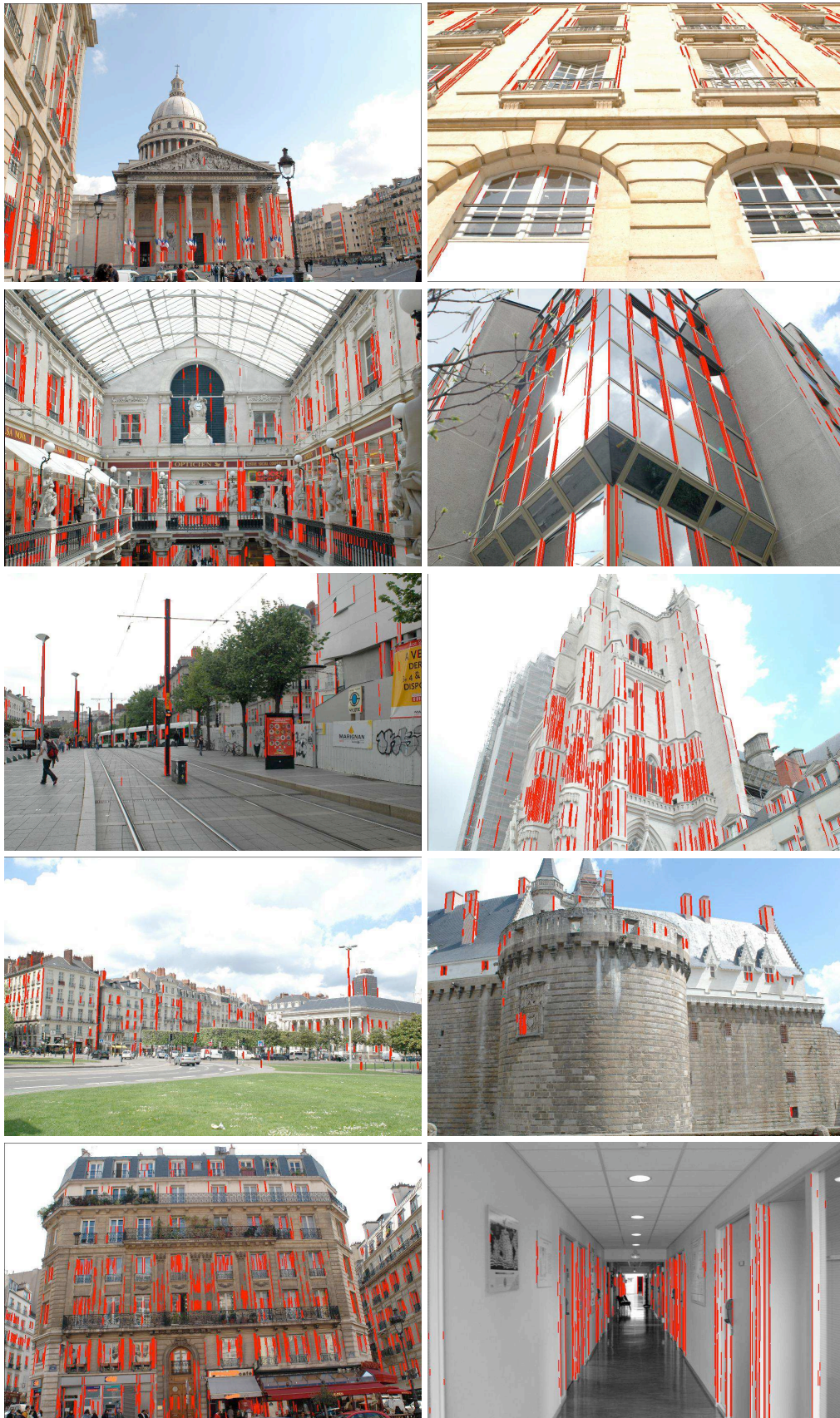
Fig. 8.2. Quelques résultats sur l'extraction et l'identification automatique des lignes et directions verticales. Les lignes détectées sont illustrées en rouge
