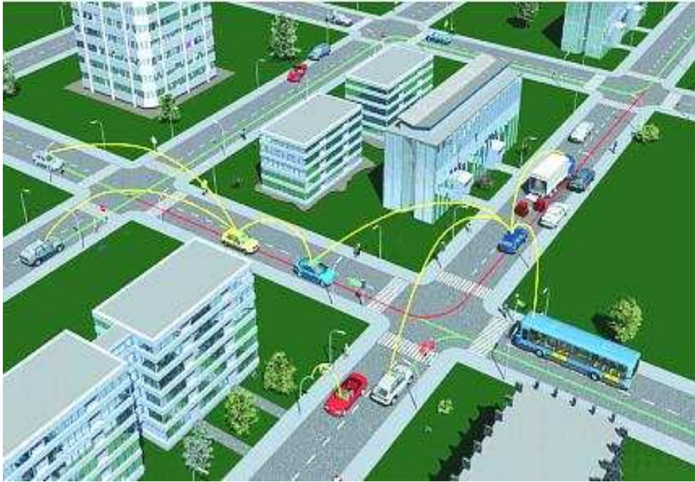
FIG. 1.15 – Communications inter-véhiculaire en environnement coopératif [31]
