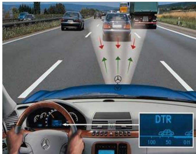
FIG. 1.8 – Principe d'un radar ACC [11]
