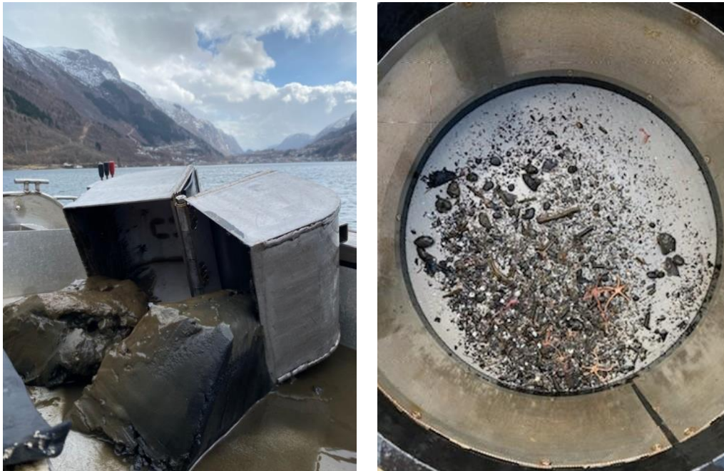
Figur 3. Van Veen-grabb (venstre) som benyttes til prøvetaking av bløtbunnsfauna, og sikterest (høyre) fra stasjon SØ10 med bunnfauna (bl.a. slangestjerner) og leirerester. Foto: NIVA
