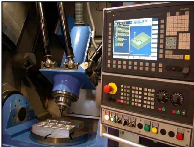
**Figure 65 : Plate-forme SPAIM intégrée sur une CN industrielle Siemens 840D**
