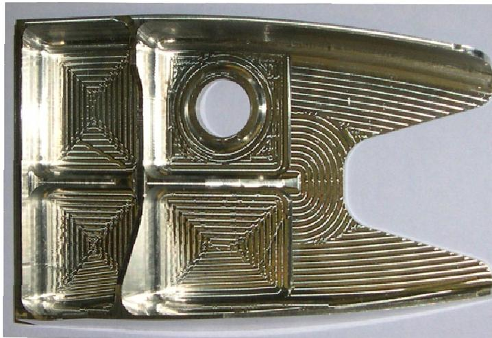
Figure 98 : Pièce test aéronautique usinée
