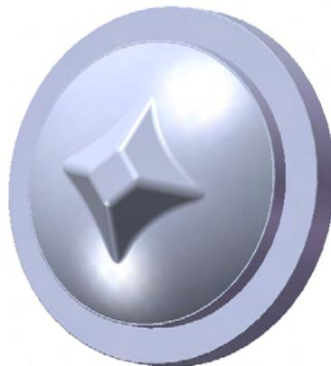
Figure 105 : Modèle de la matrice d'emboutissage étudiée
