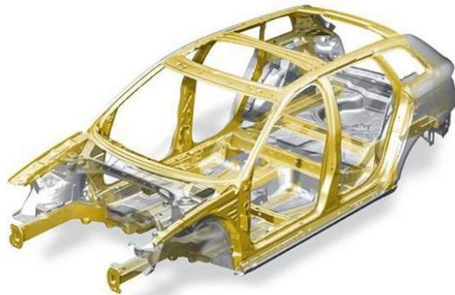
Figure 1.17 : Caisse d'un véhicule
