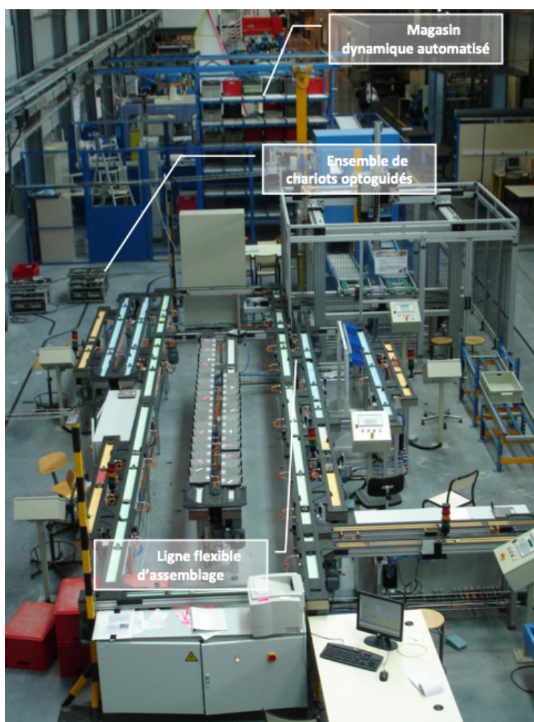
Figure 34 : Plateforme expérimentale de l'IUT de Nantes représentant un système de production. Cette plateforme pourrait être le support au développement de micromondes expérimentaux (photo extraite de Cardin, 2007).
