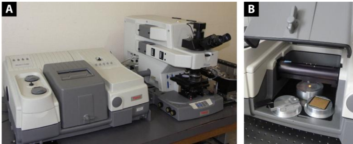
Figure 2-6 – A : spectromètre infrarouge à transformée de Fourier (FTIR 5700 de Thermo-Nicolet) du Laboratoire de Planétologie et Géodynamique de Nantes. À gauche : le banc principal avec sa chambre purgée, pour les échantillons macroscopiques. À droite : le microscope. B : porte-échantillon rempli d'une poudre à analyser et référence Infragold dans la chambre du banc principal.
