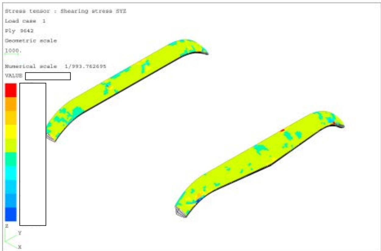
Figure 9. Distribution de la contrainte  $\sigma_{23}$  dans le Nomex de carénage
