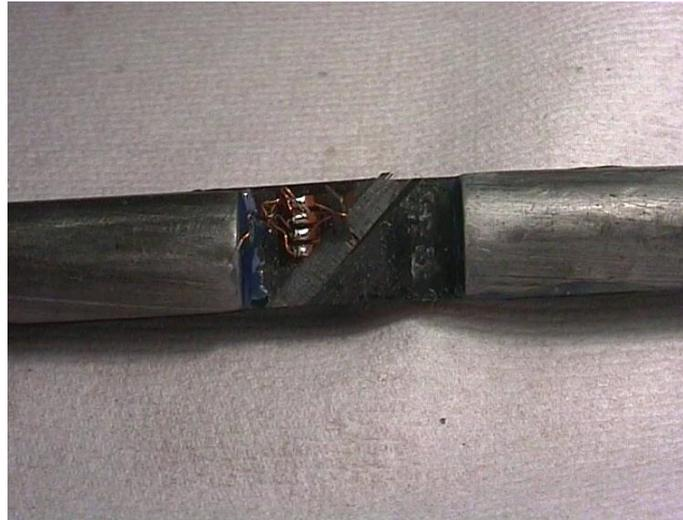
Figure 20. Faciès de rupture des éprouvettes  $(\pm 45)_{2s}$
