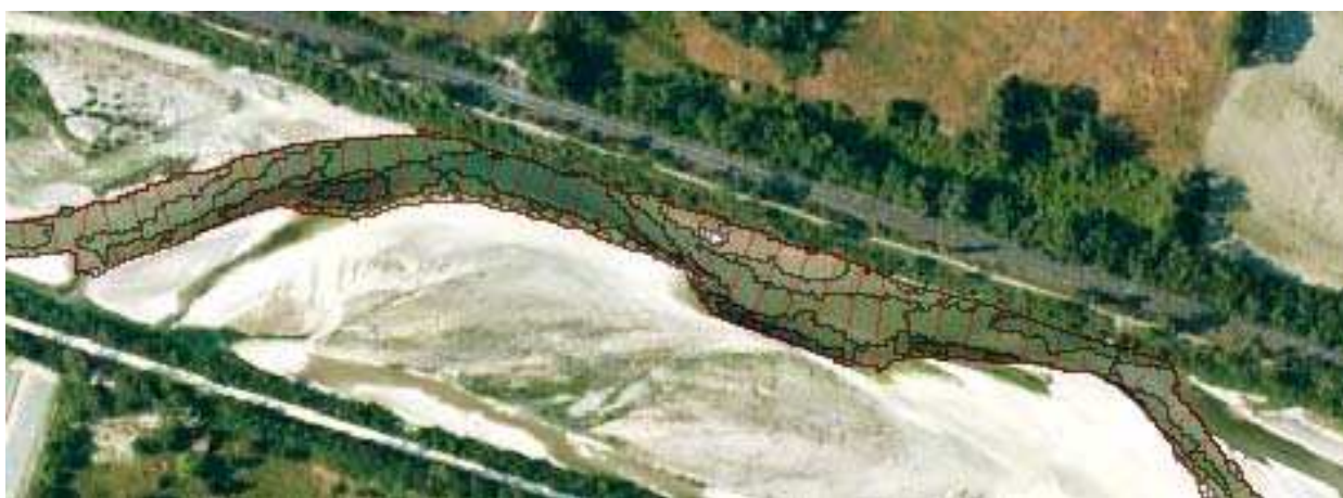
Figure 17: Superposition des deux types d'unités spatiales utilisées pour l'extraction des métriques (en rouge : DGO ; en noir : polygones de segmentation).
