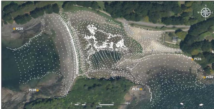
Figure 27 – Répartition des points de mesures DGPS et localisation des points de calage.
