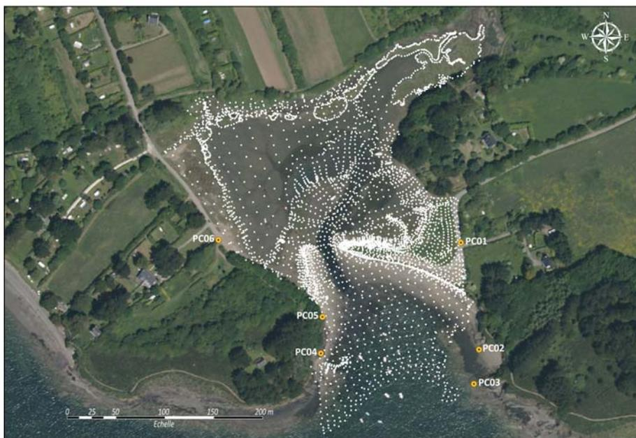
Figure 31 – Répartition des points de mesures DGPS et localisation des points de calage
