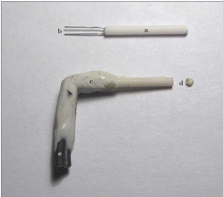
a. Faiblesses mécaniques des thermomètres Pt100 employés.
