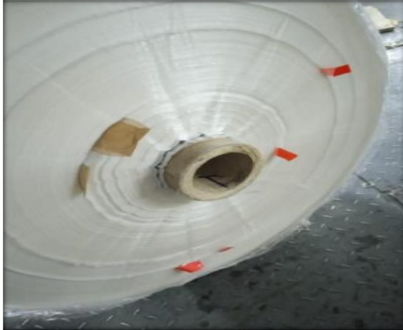
Figura 17: Merma del área de extrusión
