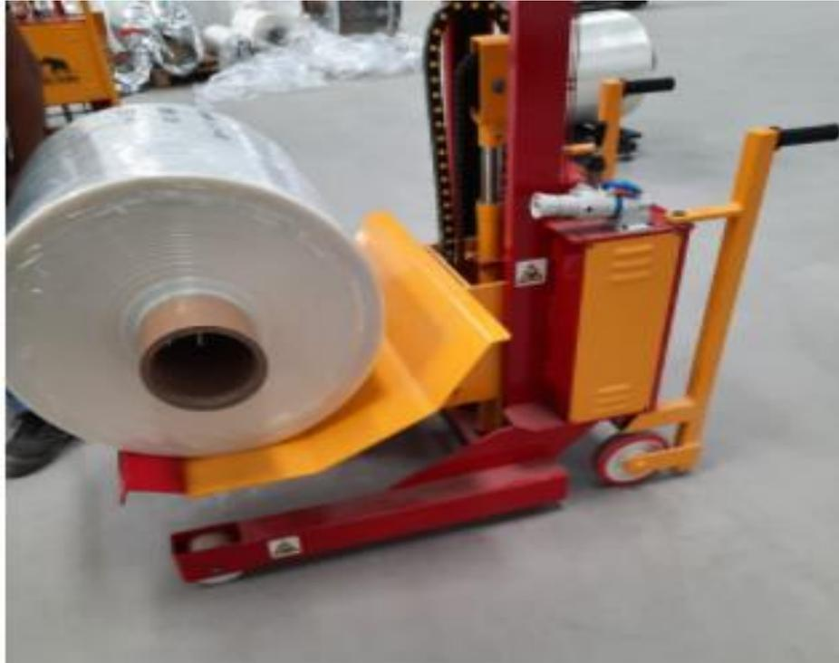
Figura 42: Apilador semi-eléctrico
