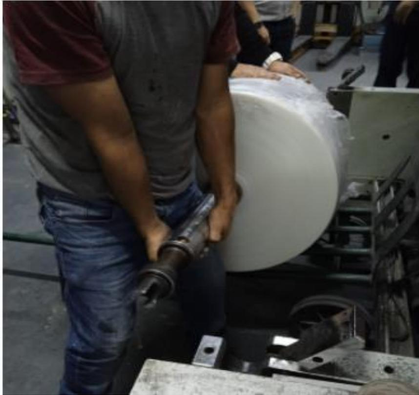
Figura 37: Montaje de bobina lado derecho.
