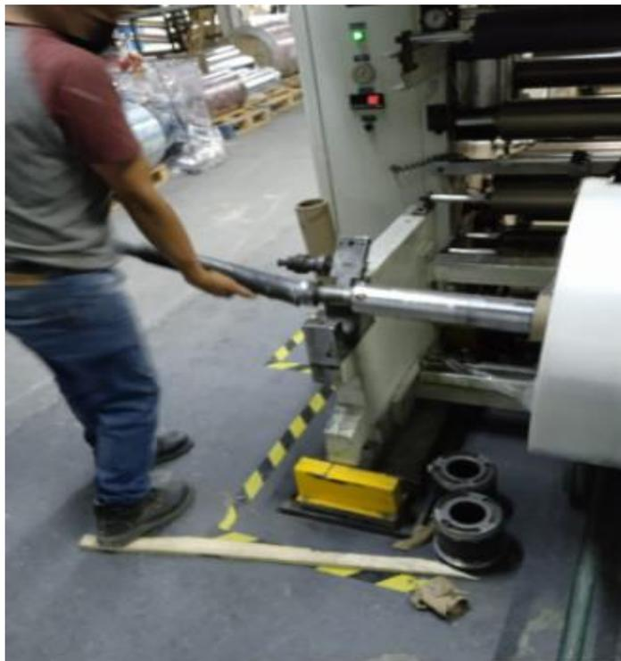
Figura 36: Montaje de bobina lado izquierdo.
