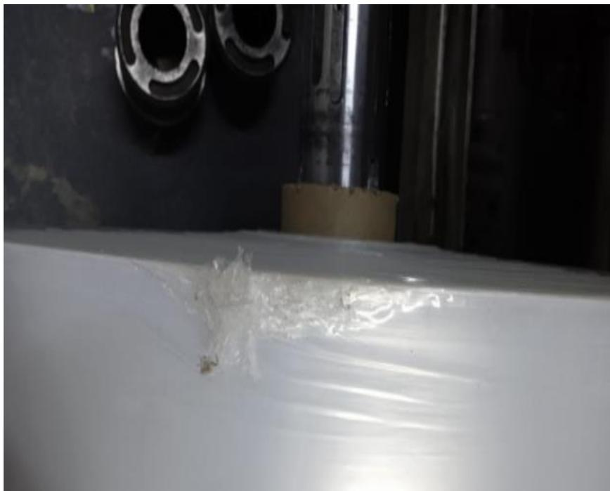
Figura 38: Daños en la bobina.
