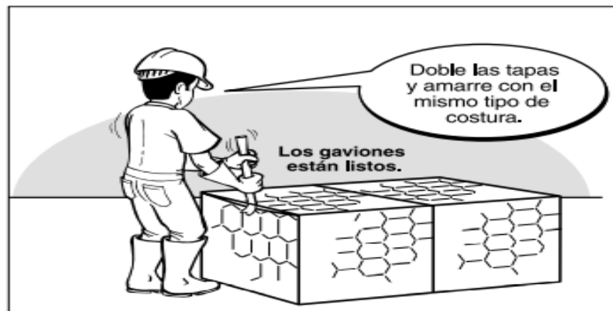
Figura N° 20: Detalle de la etapa de cierre del gavión tipo caja
