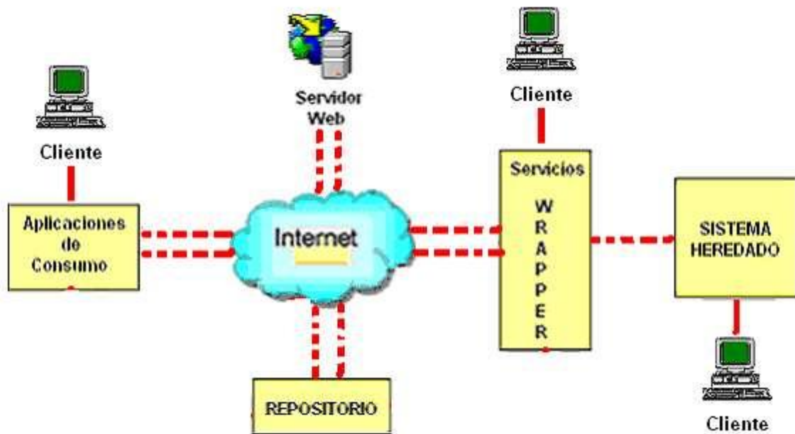
Figura 4.2. Arquitectura Conceptual de Integración de Sistemas Heredados utilizando Web Services
