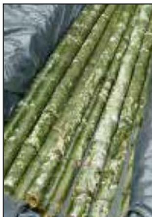
Figura 57 : Preservación química (bambú inmerso en solución de bórax y ácido bórico)
