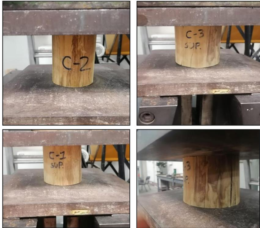
Figura 133 : Ensayo de compresión
