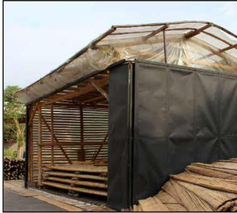
Figura 60 : Secado del bambú en secadores solares
