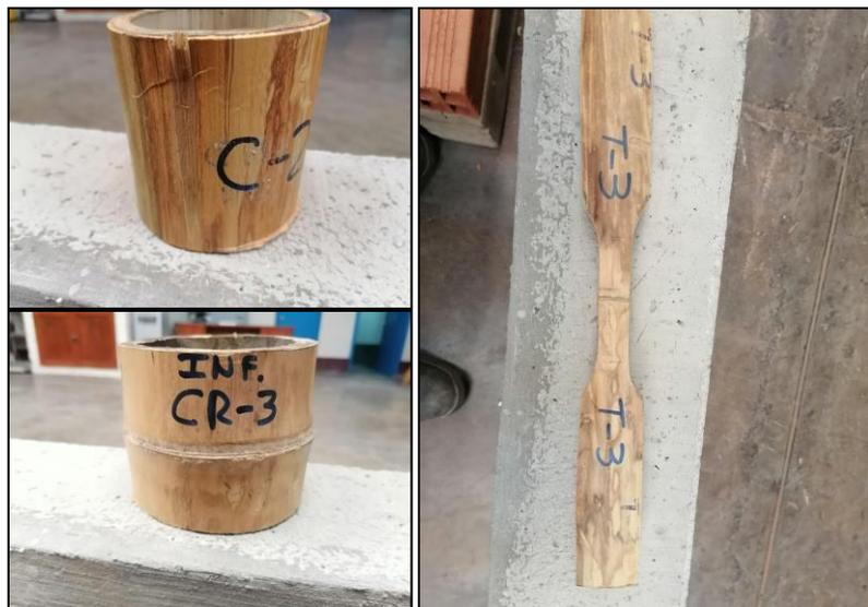
Figura 132: Corte, maquinado y rotulado de muestras para ensayos
