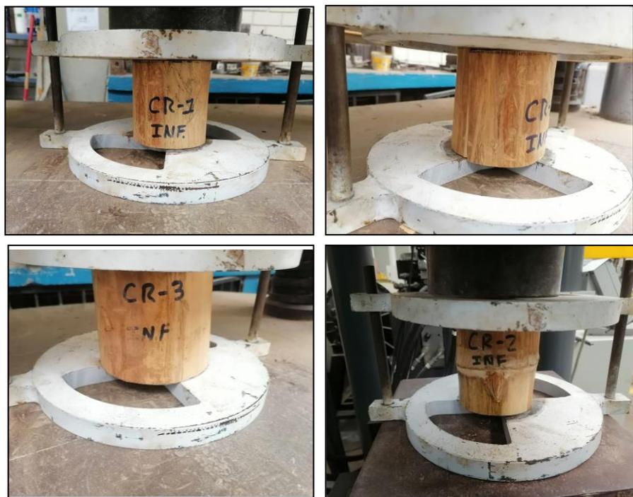
Figura 134 : Ensayo de corte
