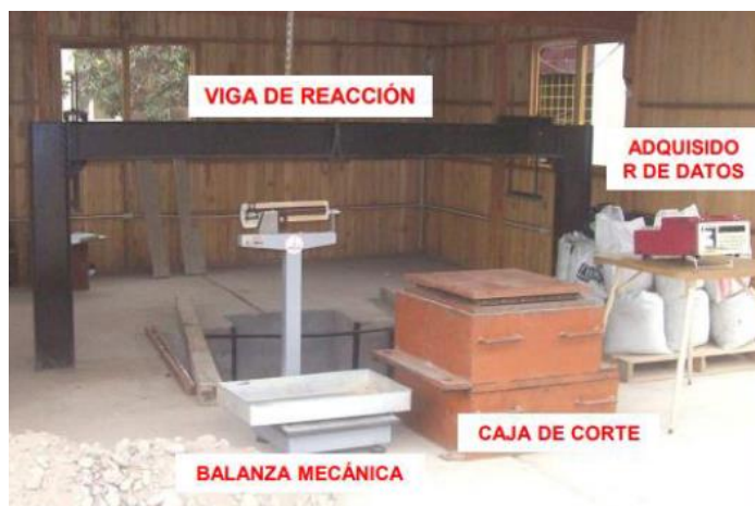
Figura 5. Equipos y dispositivos para el ensayo de corte directo a gran escala en CISMID.
