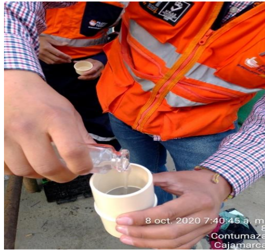
Figura 96. Vertiendo la mezcla del tubo a través de la malla o tamiz Fuente: Elaboración Propia de la Obra Puentes por Reemplazo en Cajamarca
