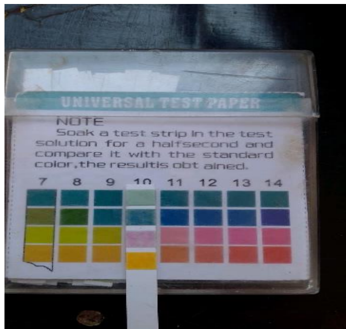
Figura 108: Resultado de 11 pH de agua tratada de río
