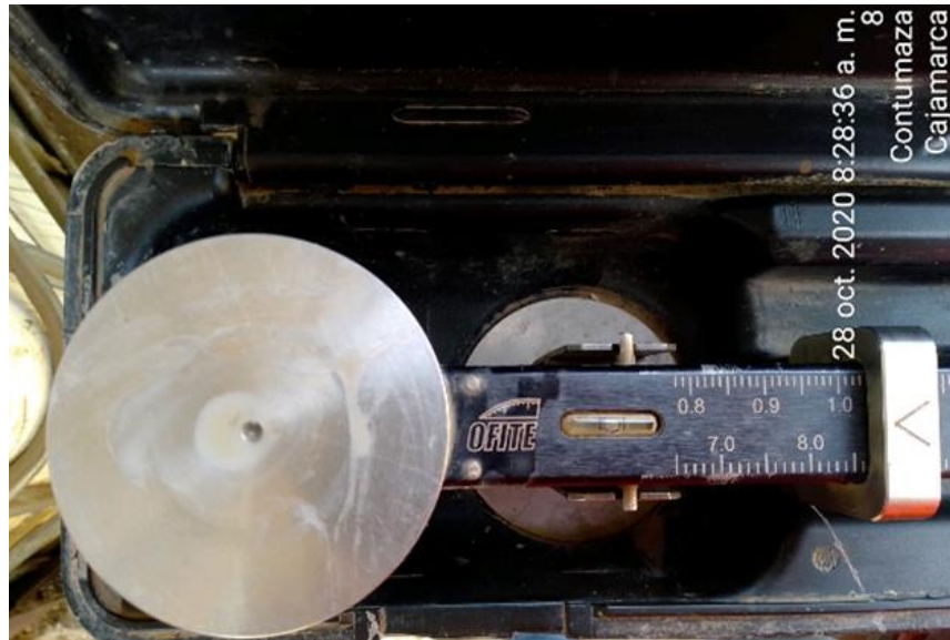
Figura 21: Balanza de Lodos Baroid
