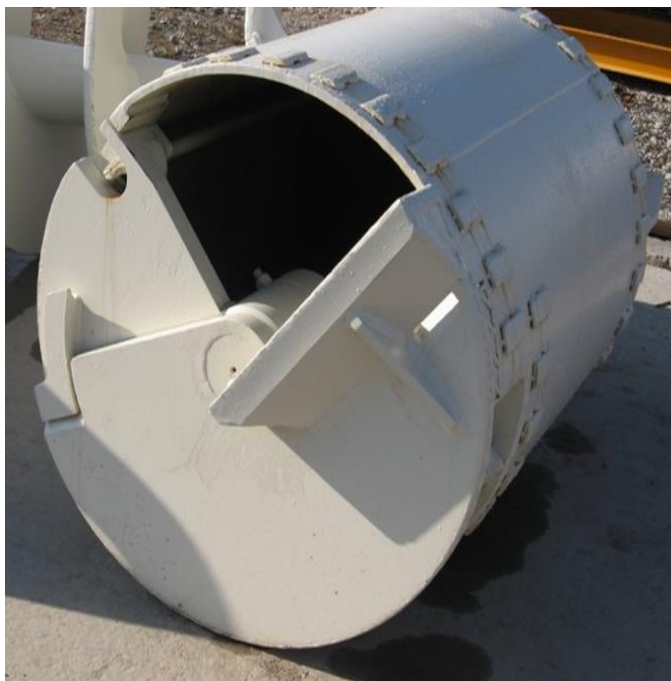
Figura 64. Herramienta de perforación (Balde)
