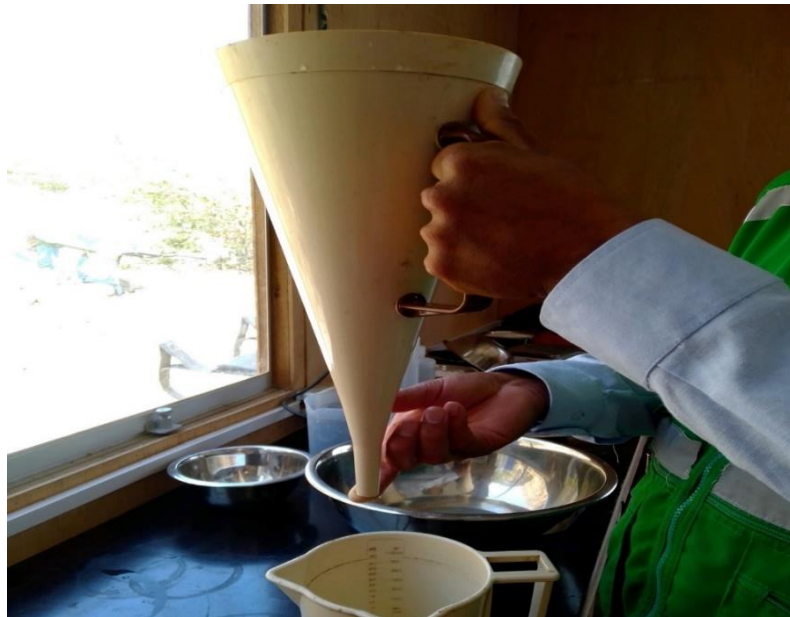
Figura 114: Viscosidad del agua tratada
