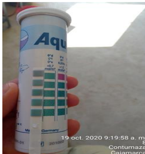
Figura 24: Cintas de dureza (Indicadores)
