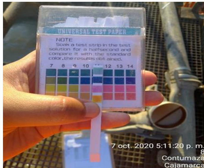
Figura 99. Cintas para comprobar el pH del lodo de polimérico
