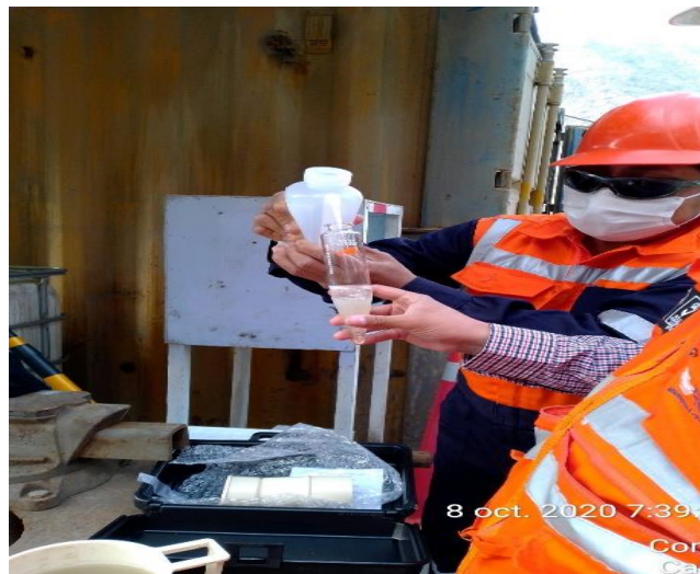
Figura 95. Agregando agua limpia para la línea denominada “Water to Here”
