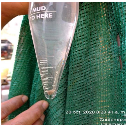
Figura 72. Verificación del lodo de perforación (Lodo polimérico) Fuente: Elaboración Propia de la Obra Puentes por Reemplazo en Cajamarca
