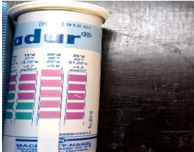
Figura 104: Resultado de 445 ppm (Partes por millón) de dureza de agua de río antes de tratar
