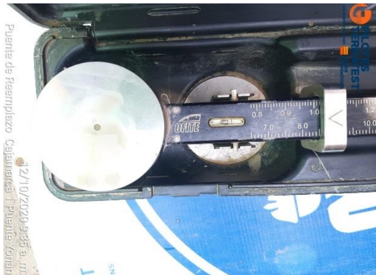
Figura 71. Verificación del lodo de perforación (Lodo polimérico) Fuente: Elaboración Propia de la Obra Puentes por Reemplazo en Cajamarca
