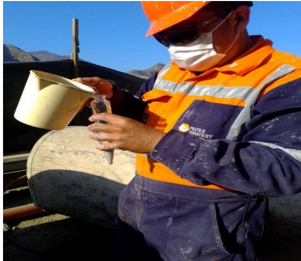
Figura 94. Tubo de medición hasta la línea denominada “Mud to Here”, con el fluido de perforación
