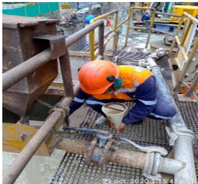
Figura 88. Ensayo de Viscosidad (Prueba del tanque de lodos)
