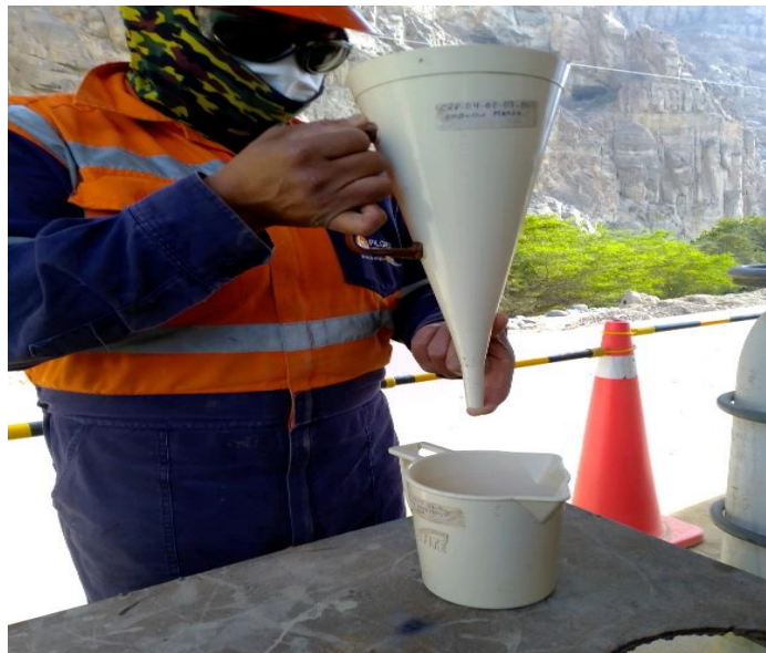
Figura 92. Ensayo de Viscosidad (Prueba de lodo de perforación)
