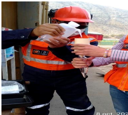
Figura 97. Agregando agua a las partículas retenidas en la malla o tamiz para poder lavar las partículas del fluido de perforación y poder retener únicamente arenas limpias
