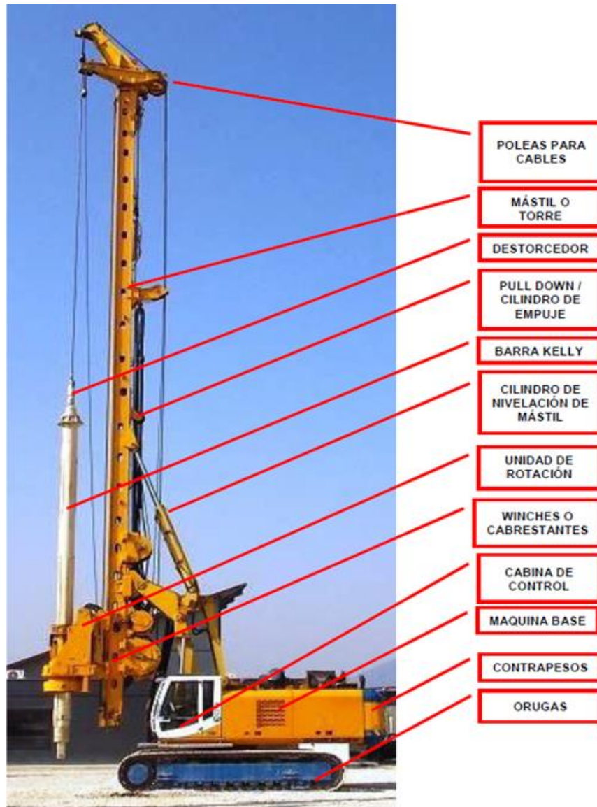
Figura 15: Maquinaria de ejecución para pilotes
