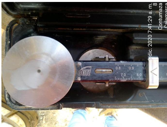
Figura 100. Ensayo de densidad del lodo polimérico
