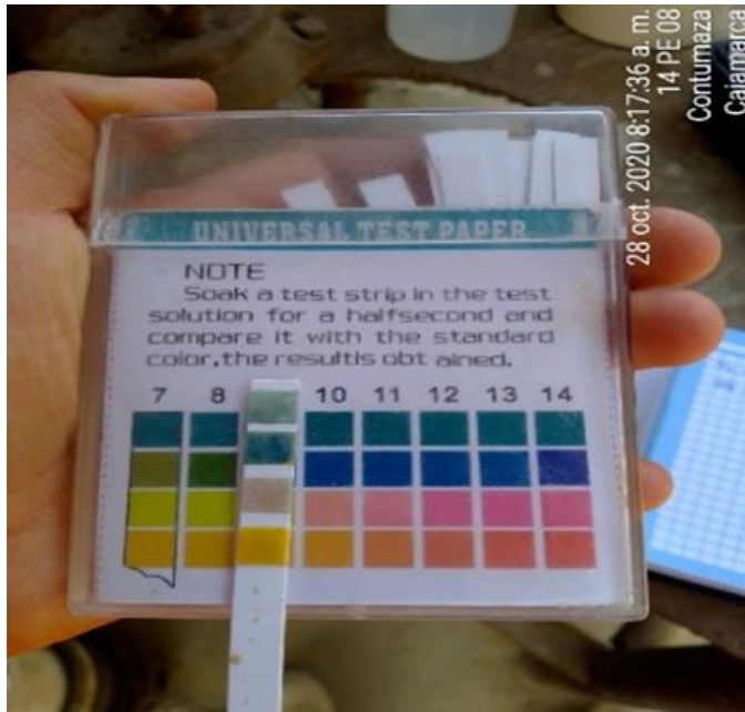
Figura 70. Verificación del lodo de perforación (Lodo polimérico) Fuente: Elaboración Propia de la Obra Puentes por Reemplazo en Cajamarca
