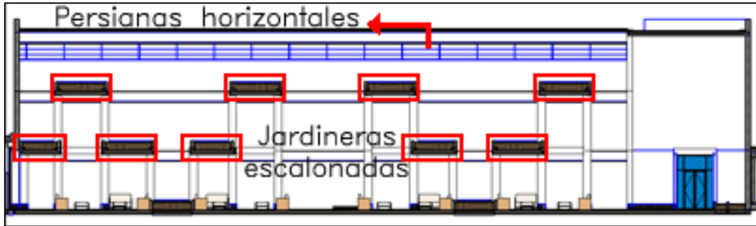
Ilustración 65: Control de deslumbramiento. Fuente: Propia.
