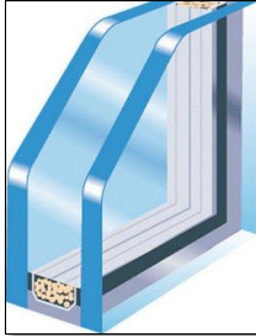
Ilustración 54: Esquema de doble vidrio hermético. Fuente: Internet.
