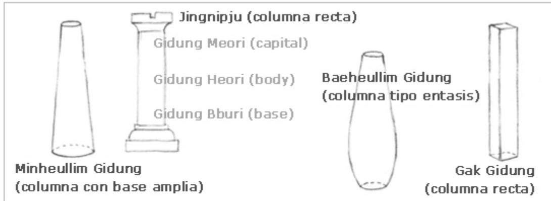
Ilustración 56. Tipos de columnas de una Hanok.
