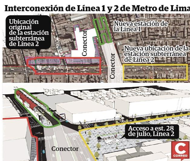
Figura 17: Vista planta y 3D de la antigua y nueva ubicación de la estación subterránea de Línea 2 para la interconexión entre a Línea 1 y 2 de Metro de Lima
