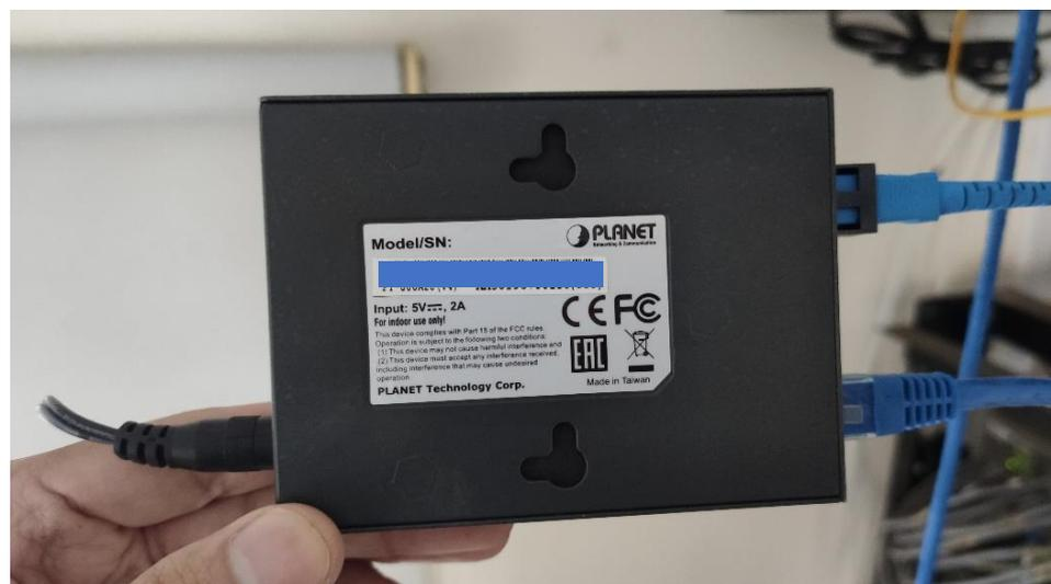
Figura 5: Conversor de medios, vista inferior.
