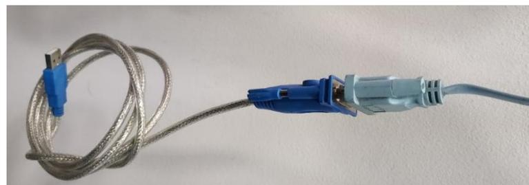
Figura 31: Cable de consola y cable adaptador Rs-232 / USB
