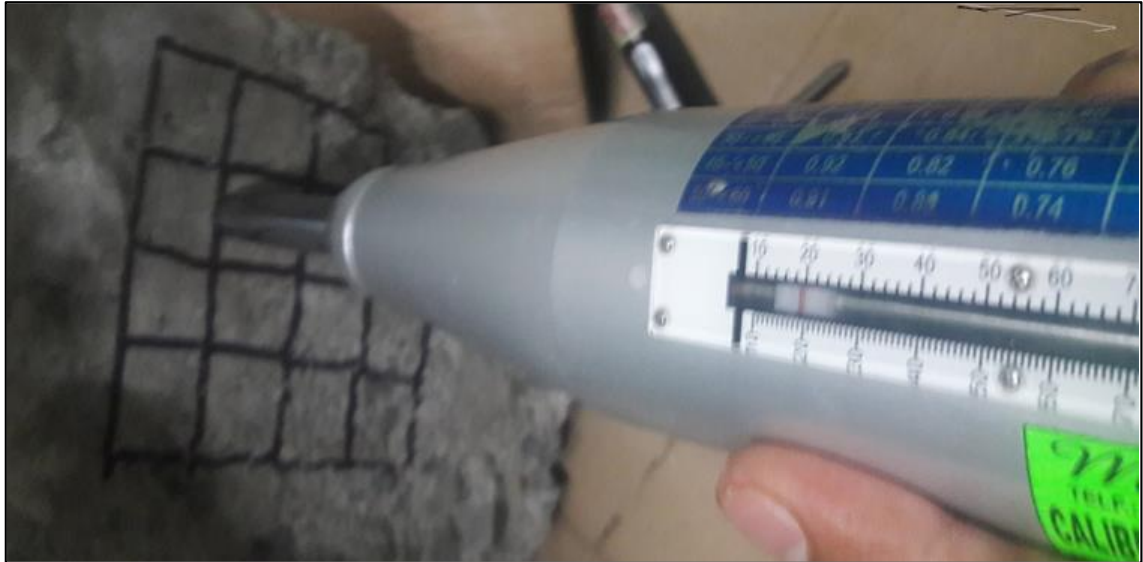
Figura 39.- Imagen del proceso de esclerometría.
