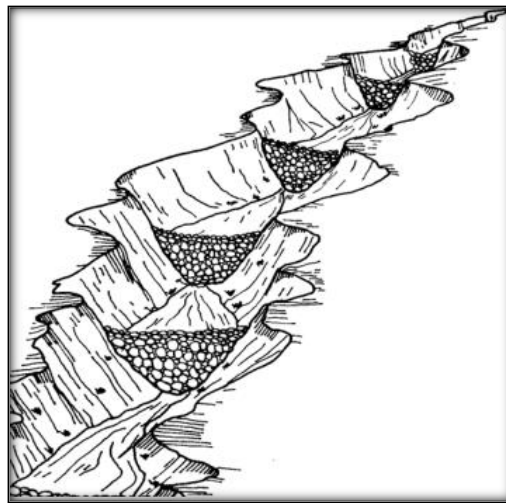
Figura N° 57: Estructuras de detención (diques) de roca.
