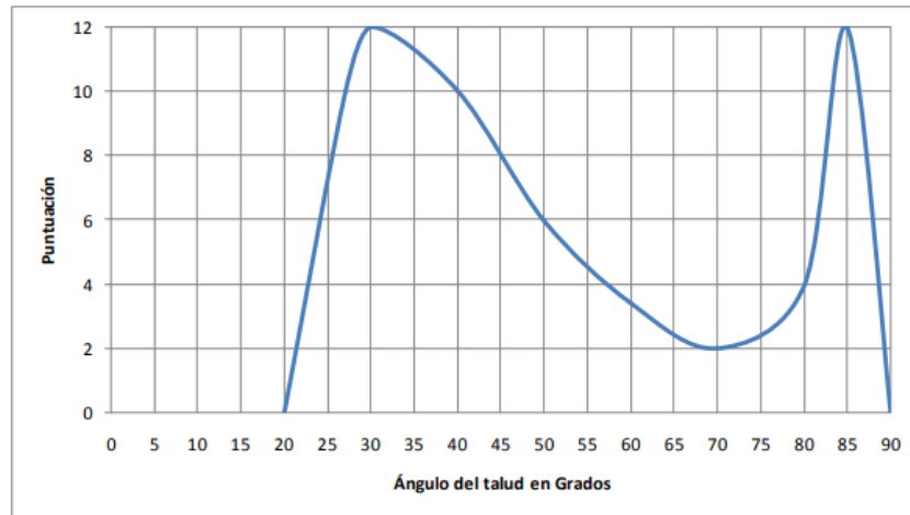
Figura N° 37: Puntuación para caídas de roca según ángulo del talud.
