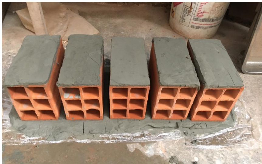
Figura 27: Capa de cemento y yeso para prueba de compresión
