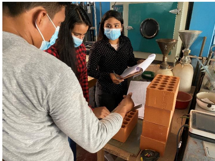
Figura 17: Medición de alabeo.
