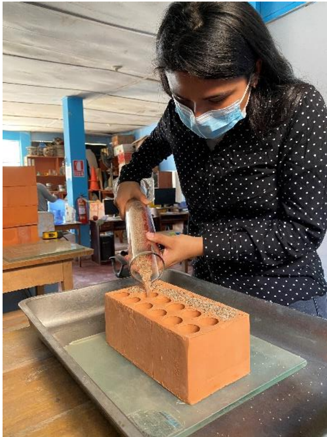
Figura 18: Relleno de perforaciones tubulares.
