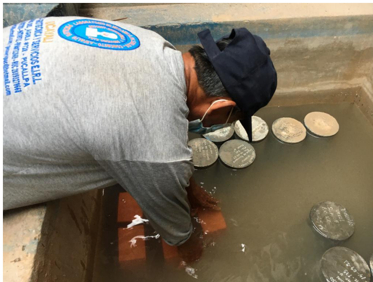
Figura 22: Sumersión de muestra 24hrs.
