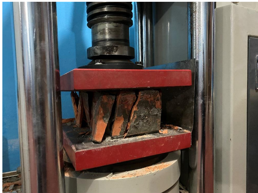
Figura 31: Ensayo de Compresión ladrillo King Kong 18 huecos.
