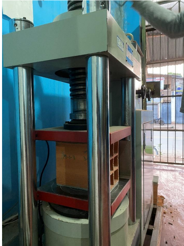
Figura 28: Muestra centrada en prensa hidráulica de ladrillo pandereta 1.
