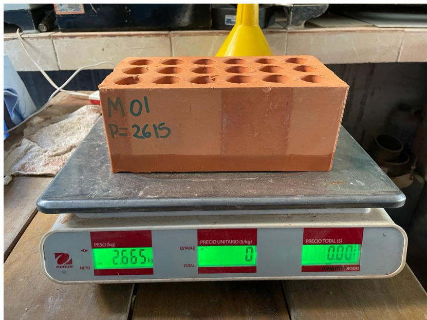
Figura 25: Peso de muestra de ladrillo sumergido.
