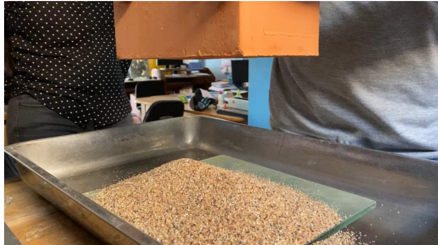
Figura 20: Elevación de muestra posibilitando que la arena de las perforaciones caiga.
