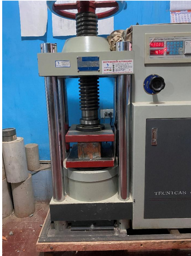
Figura 30: Muestra centrada en prensa hidráulica de ladrillo King kong 18 huecos.
