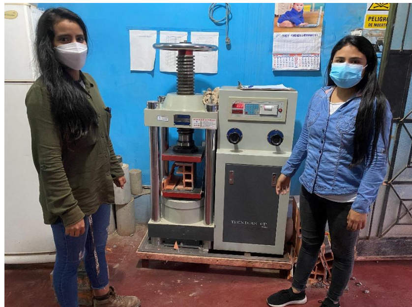
Figura 29: Ensayo de Compresión ladrillo pandereta 1.
