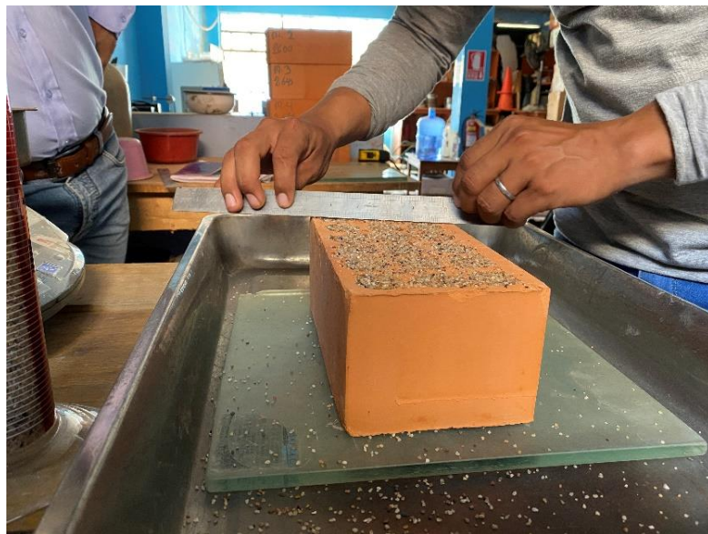
Figura 19: Nivelación de arena en las perforaciones.
