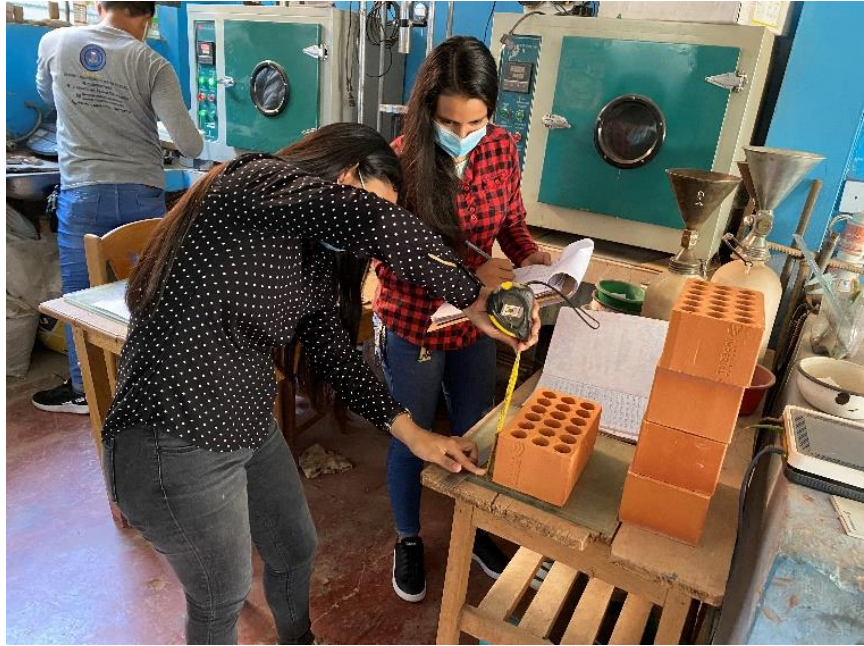
Figura 14: Unidad de medida de ladrillo King Kong 18 huecos.
