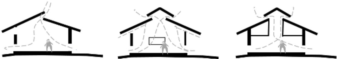
*Figura 1089. Alternativas del techo y la ventilación.*
