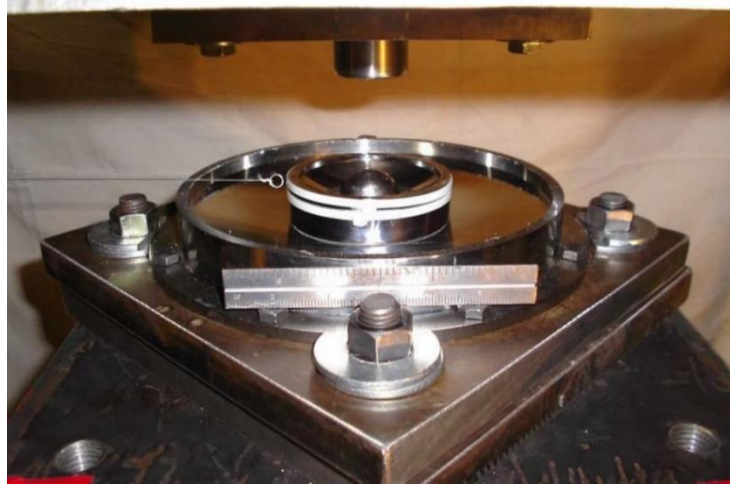
Figura 24. Fotografía de un Aislador friccional de péndulo simple ensayado.
