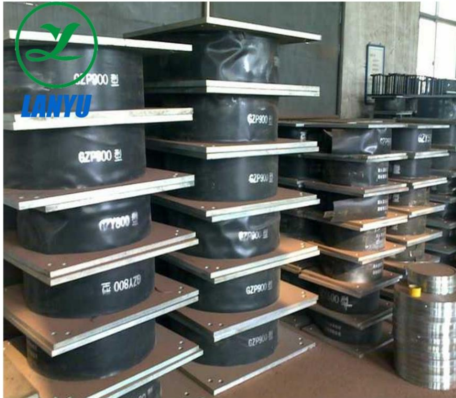
Figura 121. Almacenamiento de aisladores.
