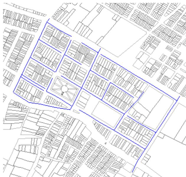
Figura 38: Trazo de la red colectora
