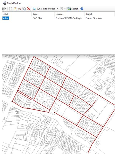
Figura 39: Importación del trazo de la red colectora
