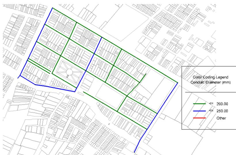
Figura 60: Esquema de diámetro de tuberías
