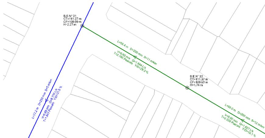
Figura 59: Diseño de colector y buzón
