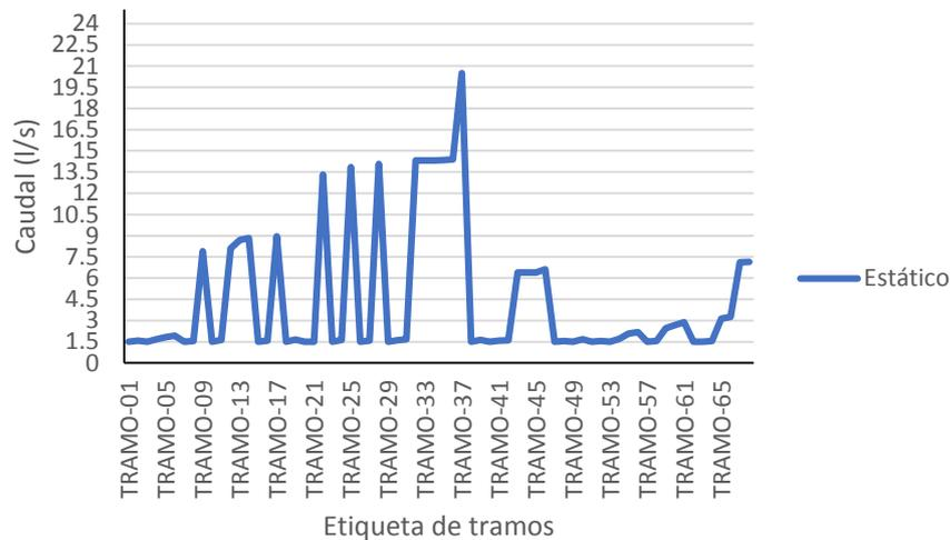
Figura 71: Caudales estáticos de la red colectora
