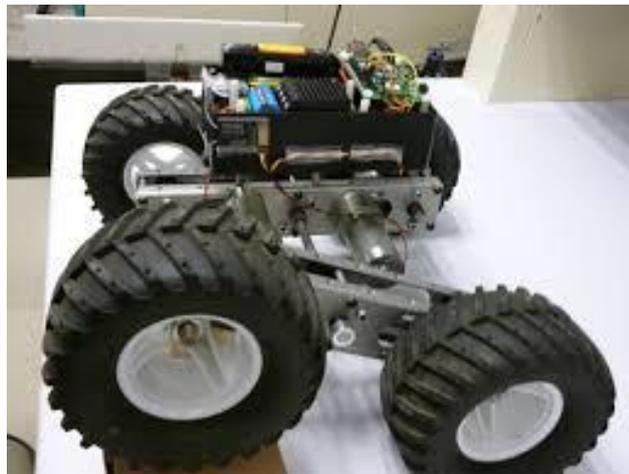
Figura 5. Sistema con locomoción por ruedas
