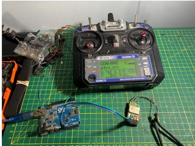
Figura 118. Circuito para la simulación de lectura del protocolo PPM
