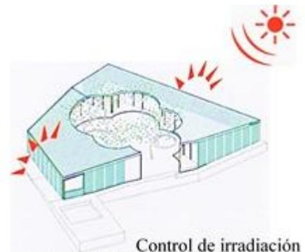
Control de irradiación solar: las baldosas cerámicas blancas en fachada y cubierta protegen al edificio del sol.
