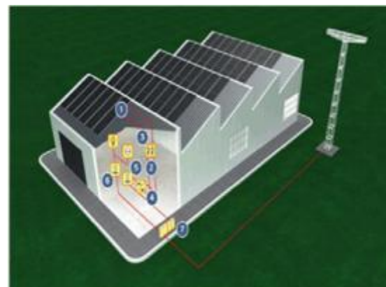
Figura N° 44: Instalación directa a la red
