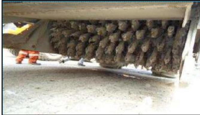
Figura 6.5 Distribución de Boquillas en la Recicladora
