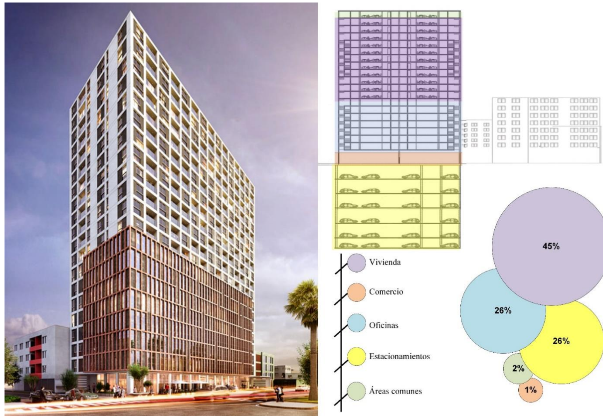
Figura 59. Diagrama de distribución de espacio por uso en el edificio. Imagen elaborada a partir del render publicado por EDIFICA (2017)
