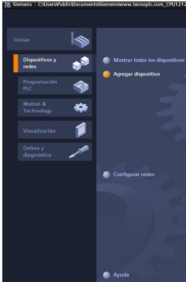
Figura 14 Agregar Dispositivo al TIA Portal
