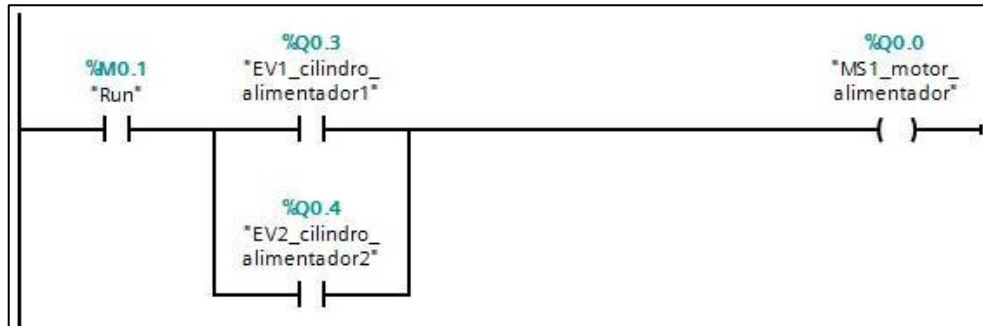
Figura 51 Segmento 5 programación de secuencia lógica de inicio
