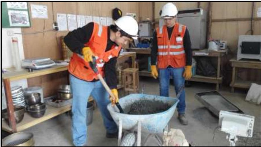
**Figura 20.** Mezclado de componentes del concreto.
