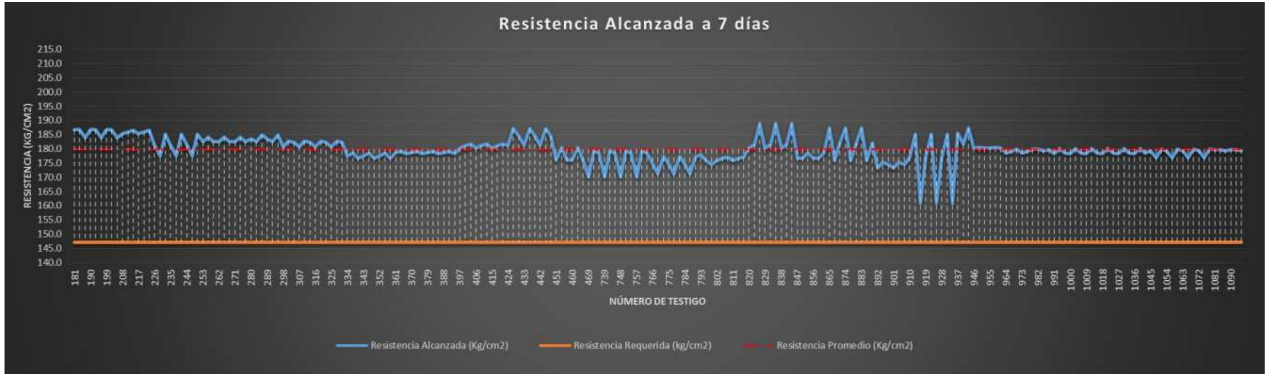
Del gráfico 10, se tiene picos y depresiones en las probetas ensayadas en la tercera semana del mes, donde la desviación estándar sea baja ya que la variación entre el valor máximo y mínimo es 28.05 kg/cm<sup>2</sup>. Estos valores incrementan y decrecen indirectamente debido a diferentes factores como procesos de moldeo de probetas y/o segregación del agregado.
