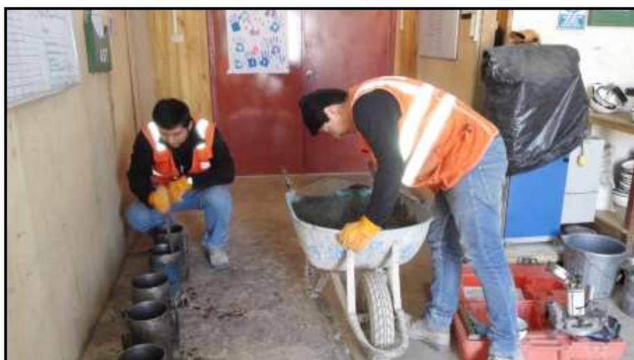
**Figura 15.** Llenado de moldes para ensayo de compresión no confinada.
