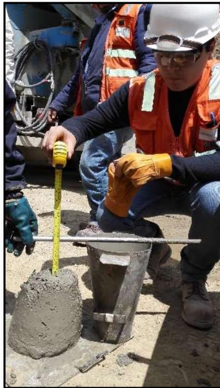
**Figura 12.** Concreto hidráulico en obra para ensayo de slump.
