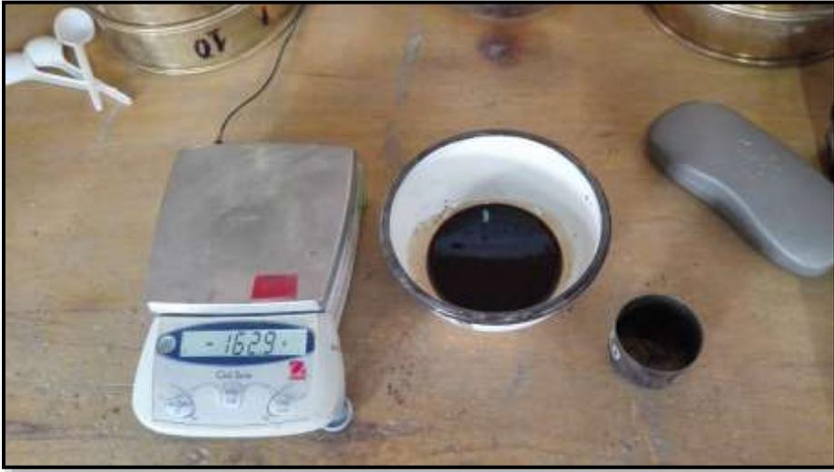
**Figura 19.** Inclusión de aditivos en la mezcla de concreto.
