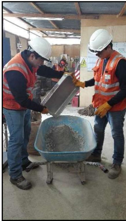
**Figura 18.** Preparación de mezcla de concreto.
