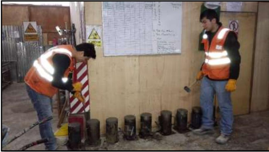
**Figura 16.** Llenado de moldes para ensayo de compresión no confinada.
