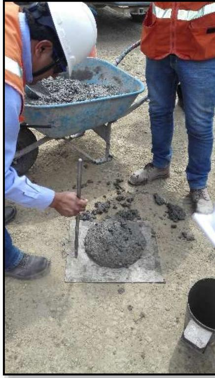
**Figura 13.** Concreto hidráulico en obra para verificación de consistencia.
