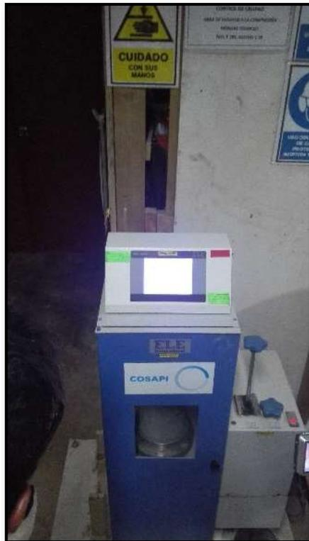
**Figura 17.** Ensayo de compresión no confinada.
