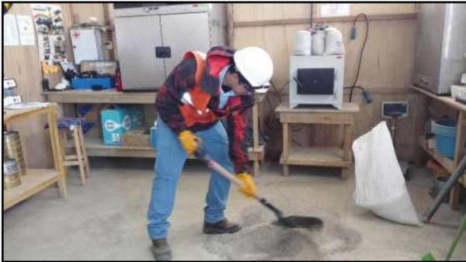
**Figura 10.** Mezclado de agregado fino para ensayos.
