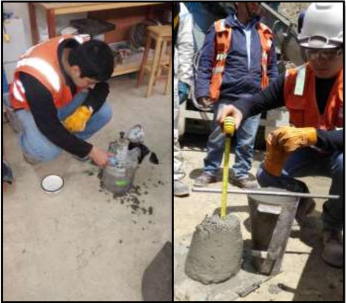
Vista de algunos pasos del proceso de moldeo de testigos de concreto.
