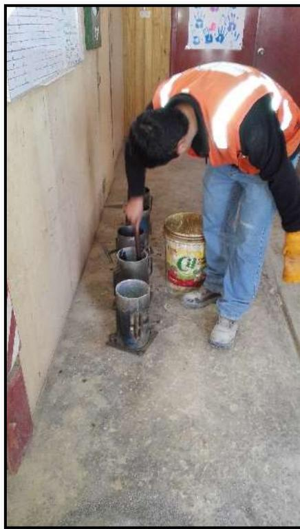
**Figura 14.** Limpieza y aplicación de desmoldante en moldes.
