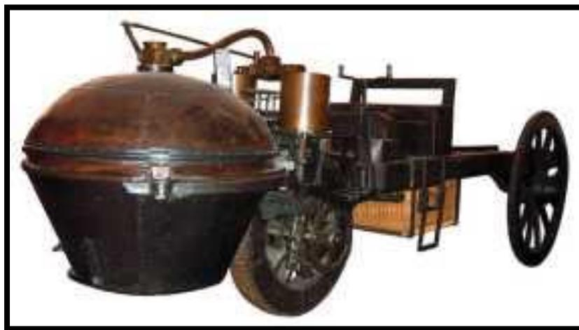
Figura 2. Primer transporte a vapor “Fardier de Cugnot”
