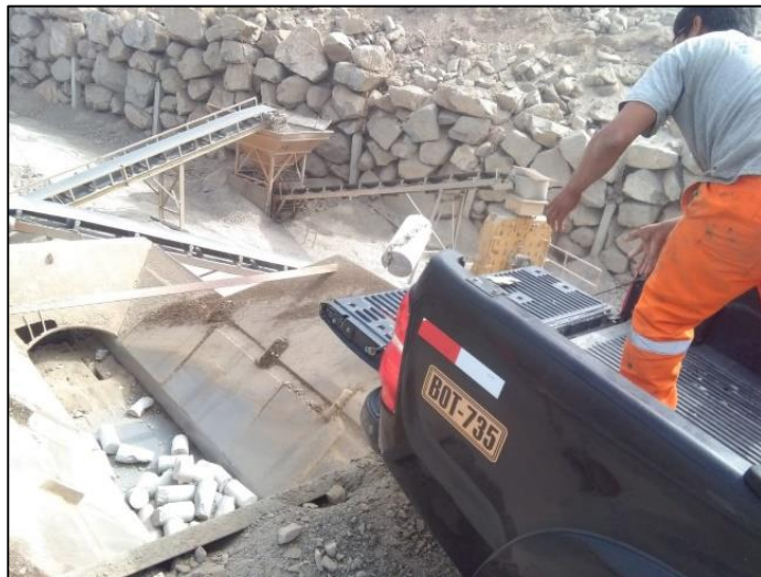
Figura 8 Colocación de las probetas de concreto en la máquina trituradora
