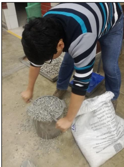
Figura 18 Retirando el agregado sobrante
