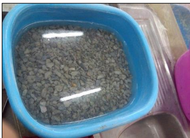
Figura 20 Agregado reciclado en remojo por 24h
