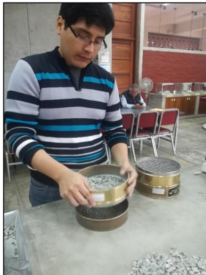
Figura 12 Tamizado del agregado
