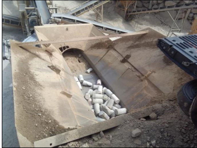
Figura 7 Triturado de las probetas de concreto
