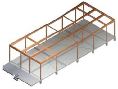
Estructura de madera con bambú sobre pilotes de concreto
