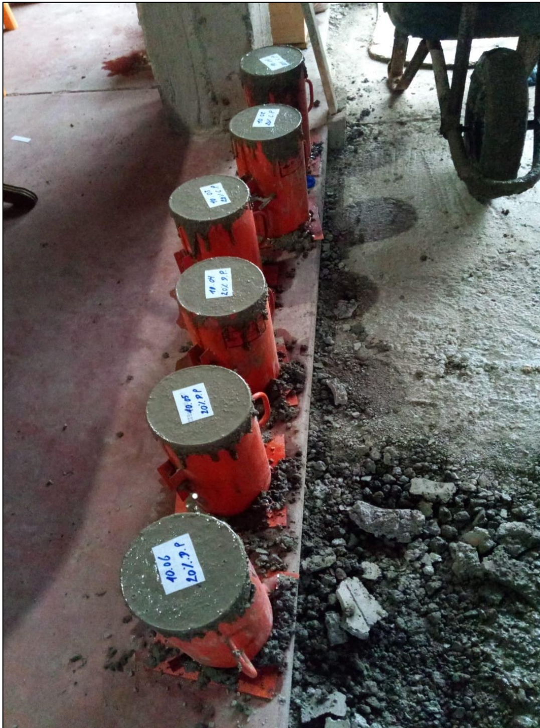
Figura N° 29: Probetas obtenidas en Obra con Adición de Arcilla en 20%
