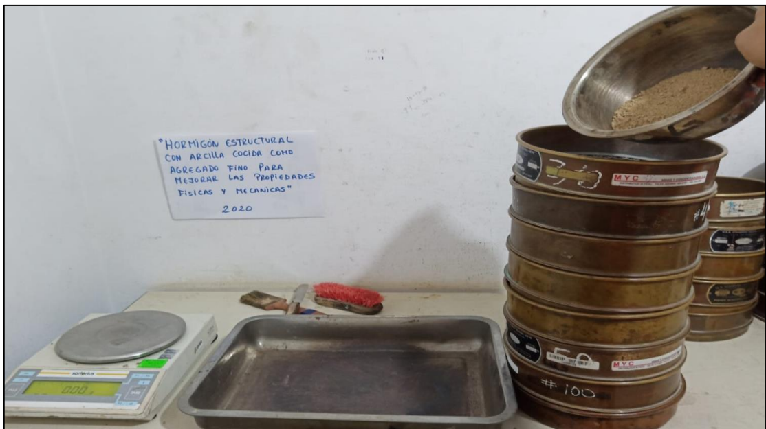
Figura N° 2: Tamices para Ensayo de Granulometría
