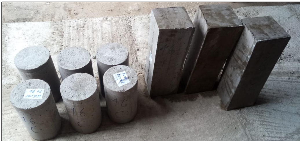
Figura Nº 66: Hormigón Endurecido para Rotura a 14 Días
