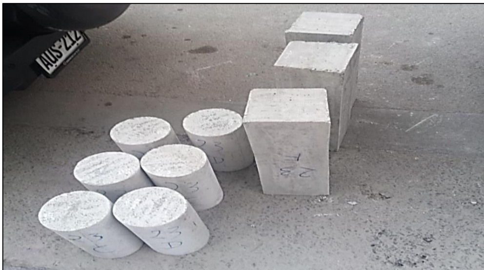
Figura N° 70: Hormigón Endurecido para Rotura a 7 Días
