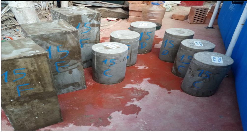
Figura Nº 65: Hormigón Endurecido para Rotura a 14 Días
