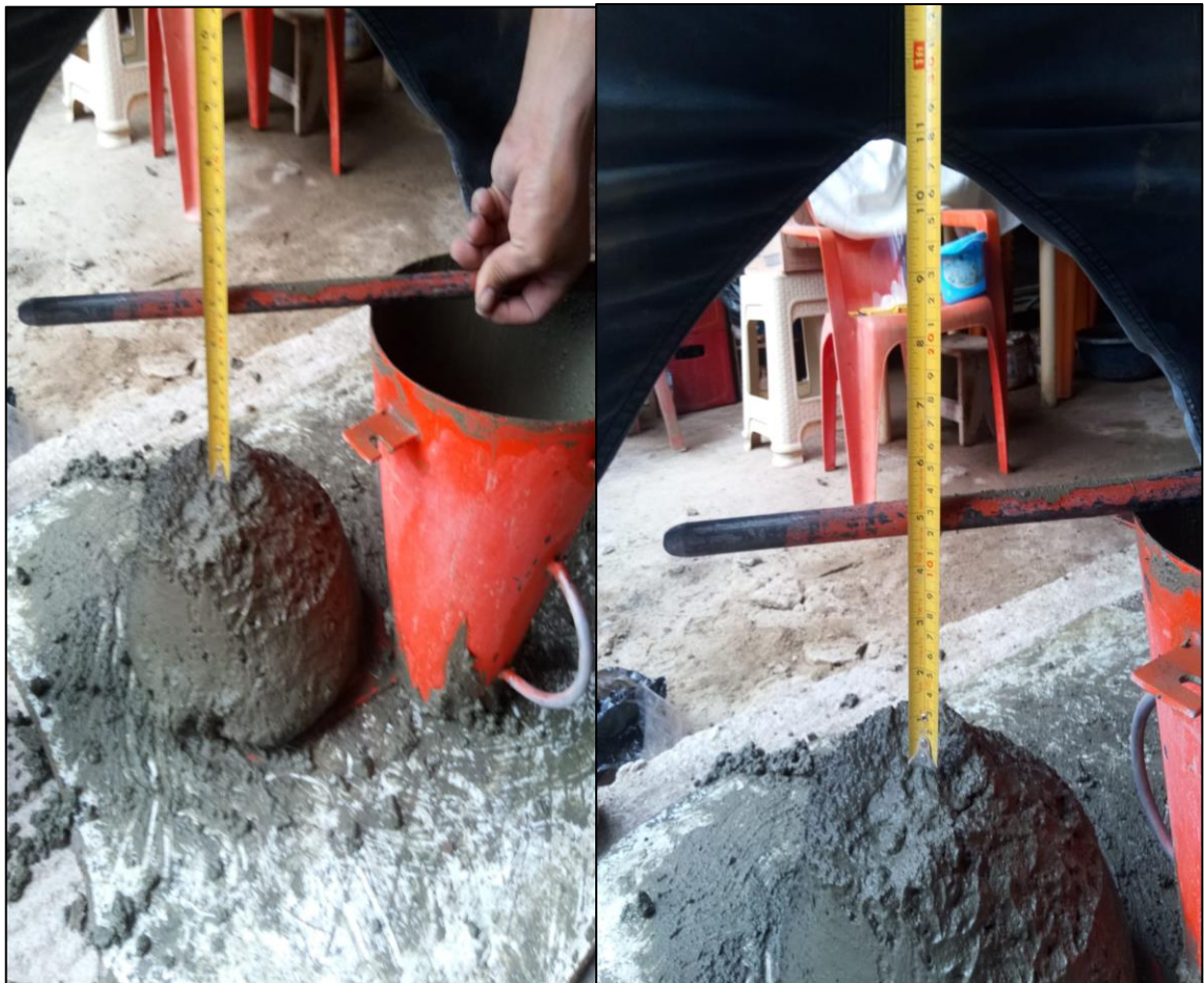
Figura N° 57: Asentamiento de la Mezcla Patrón
