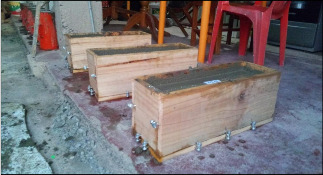
Figura N° 25: Vigas con Adición de Arcilla en 15%
