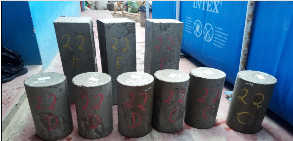
Figura N° 69: Hormigón Endurecido para Rotura a 7 Días
