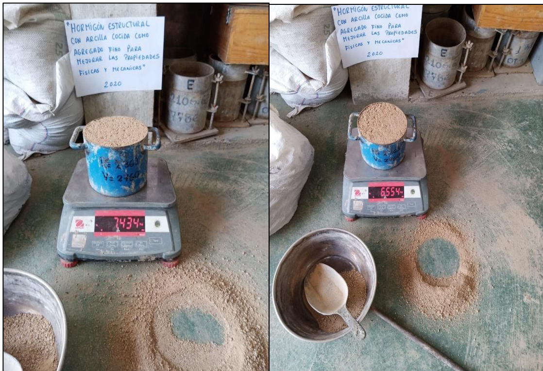
Figura N° 4: Ensayo Peso Unitario Suelto y Compactado del Agregado Fino
