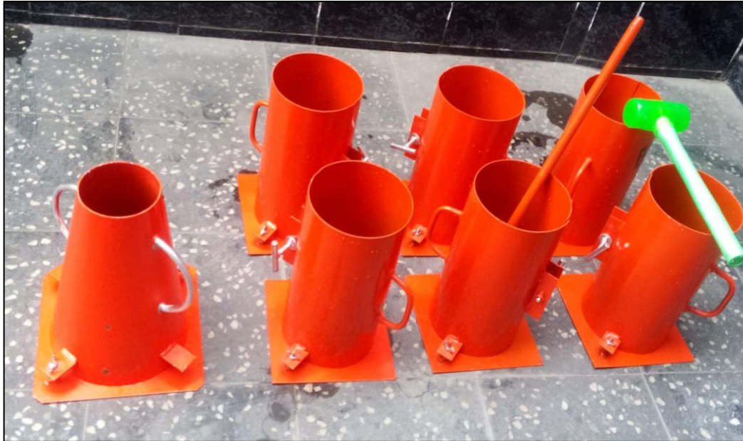
Figura N° 8: Probetas Metálicas y Cono de Abrams
