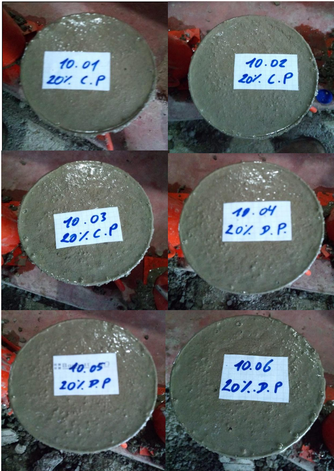
Figura N° 28: Probetas Obtenidas en Obra con Adición de Arcilla en 20%
