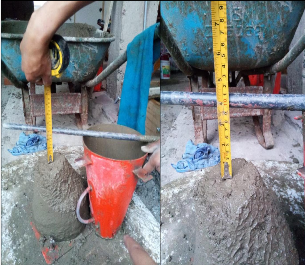
Figura N° 59: Asentamiento del Diseño con 20% de Arcilla Cocida
