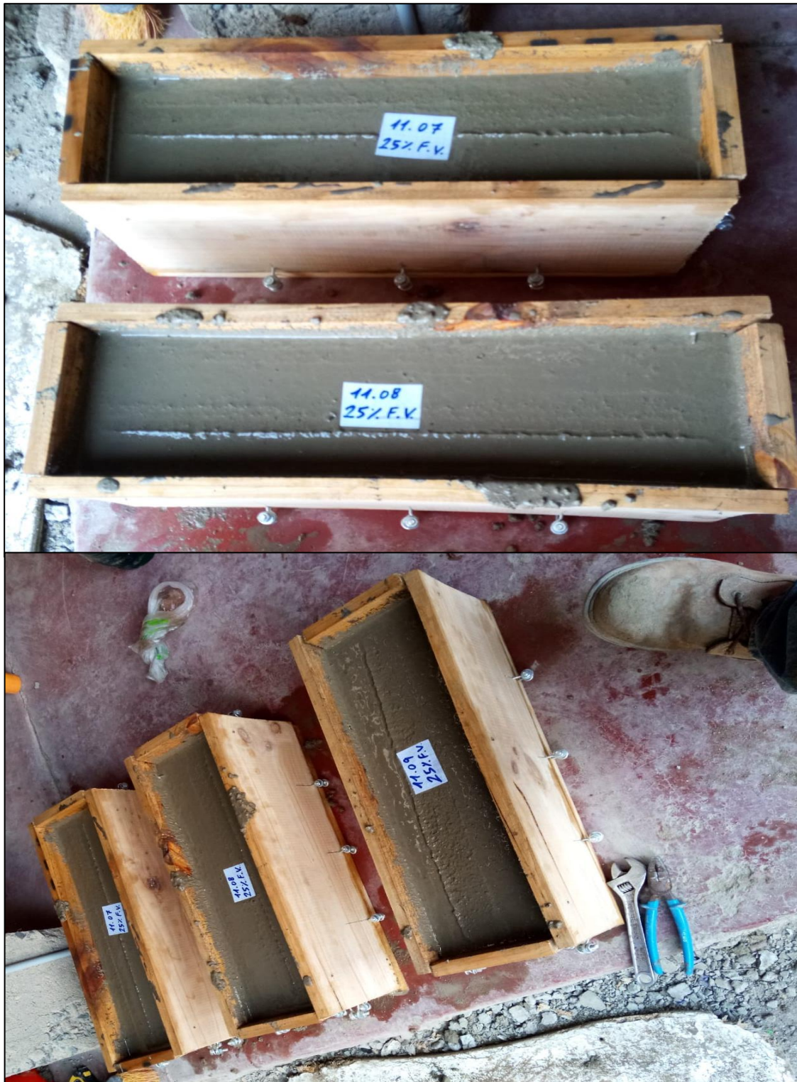
Figura N° 36: Vigas con Adición de Arcilla en 25%
