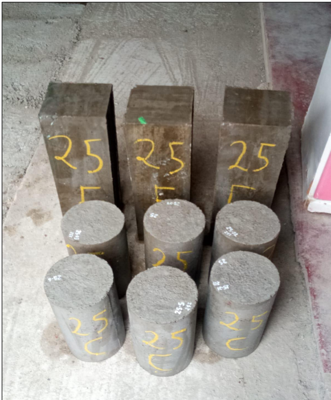
Figura N° 71: Hormigón Endurecido para Rotura a 7 Días
