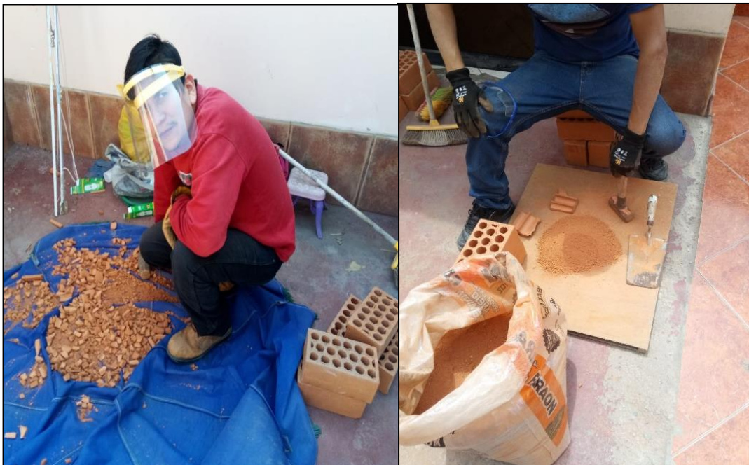
Figura N° 7: Proceso de Molido de los Ladrillos de Arcilla Cocida
