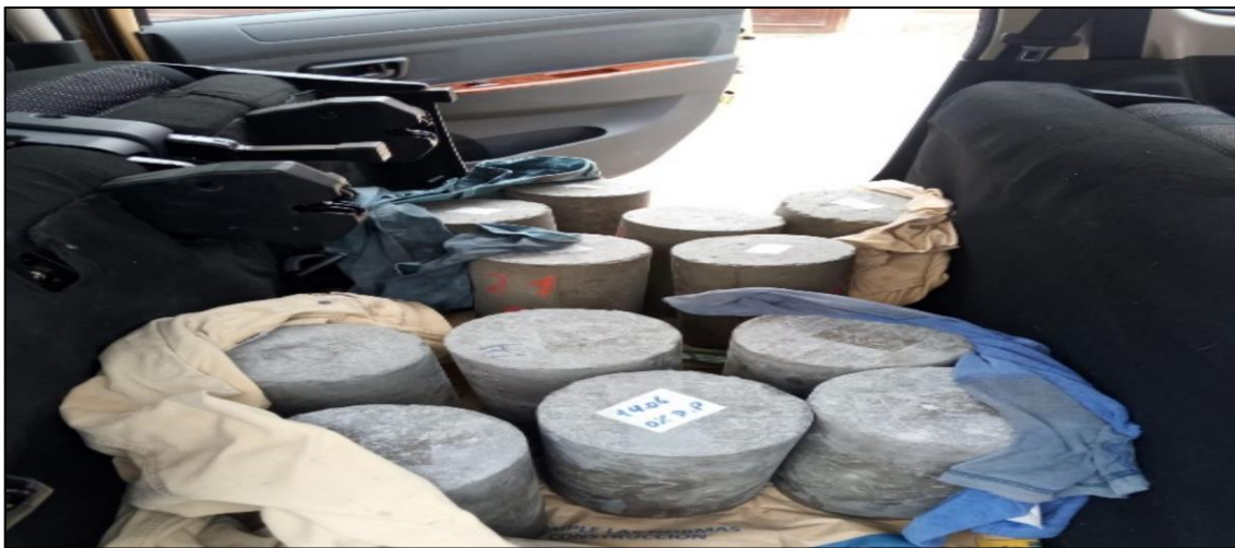
Figura N° 75: Probetas para ensayo a Tracción en Laboratorio
