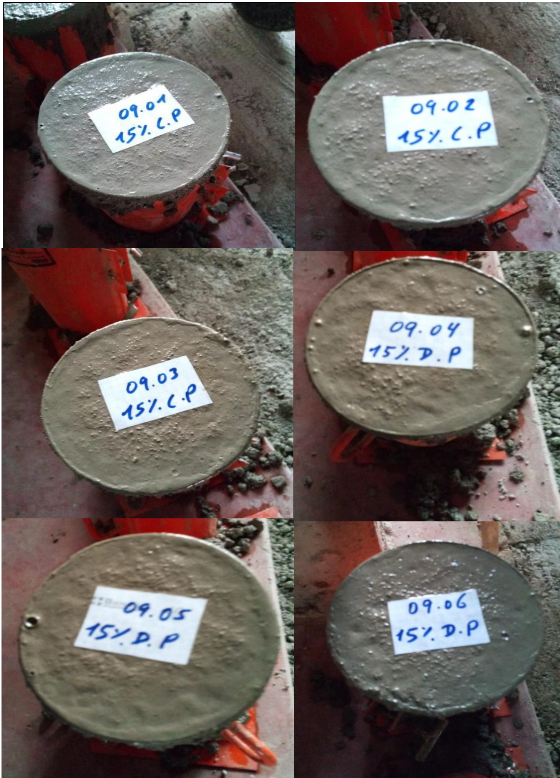
Figura N° 22: Primeras Probetas con Adición de Arcilla en 15%
