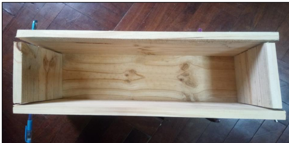
Figura N° 9: Molde de Vigas 6'' x 6'' x 20''
