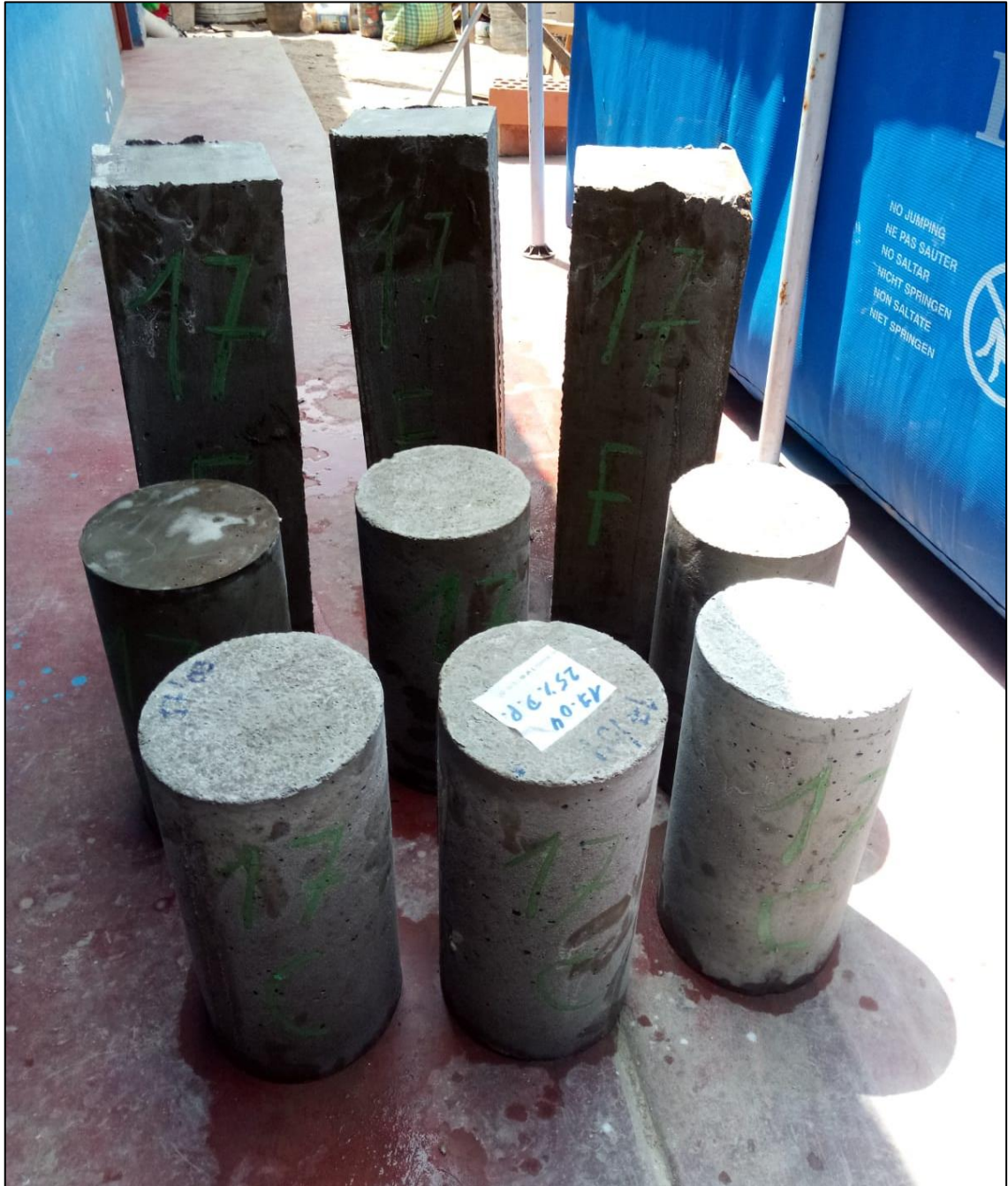
Figura N° 67: Hormigón Endurecido para Rotura a 14 Días
