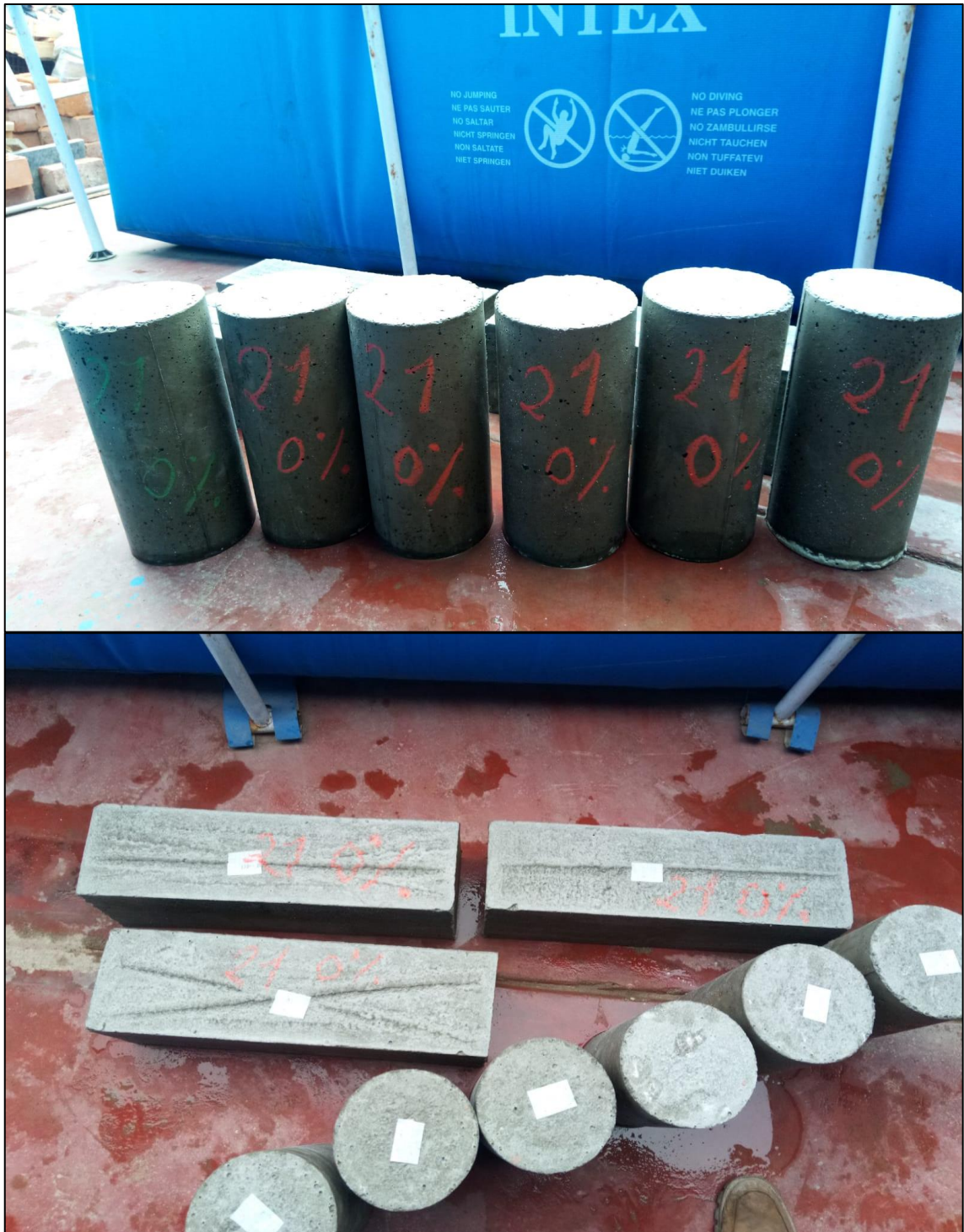
Figura N° 68: Hormigón Endurecido para Rotura a 7 Días
