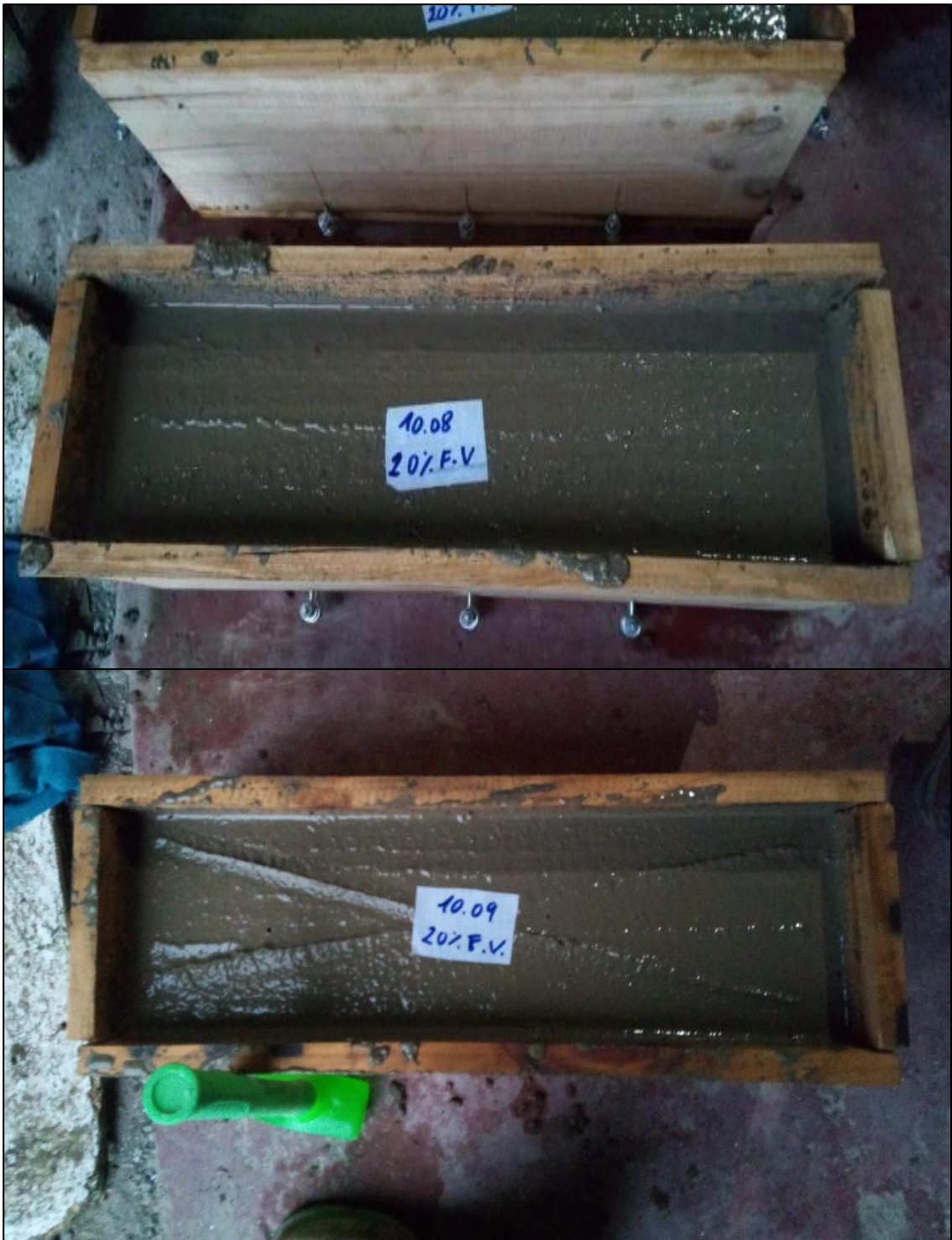
Figura N° 31: Vigas con Adición de Arcilla en 20%
