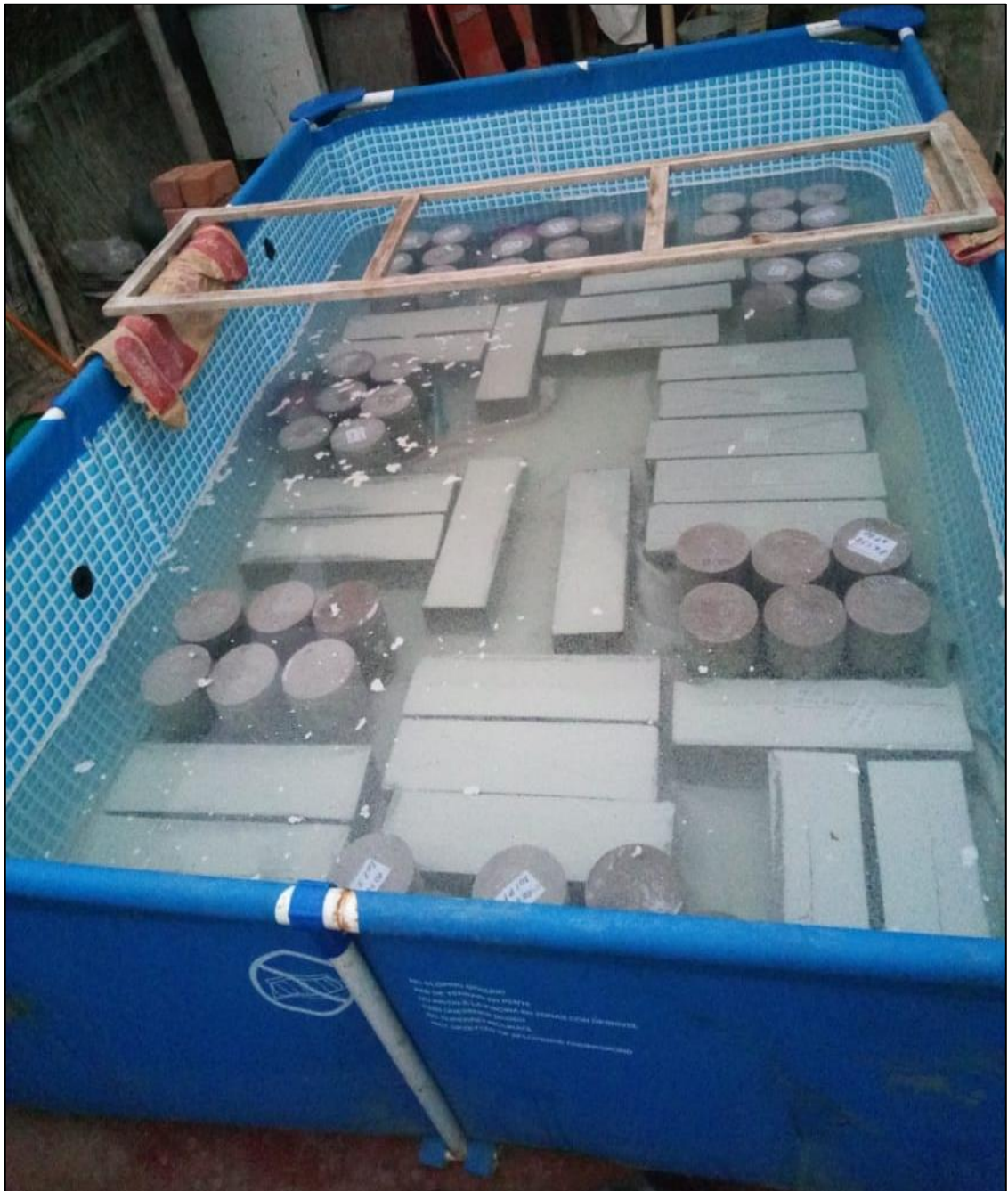
Figura N° 55: Curado en Piscina para Probetas y Vigas de Arcilla en 25%
