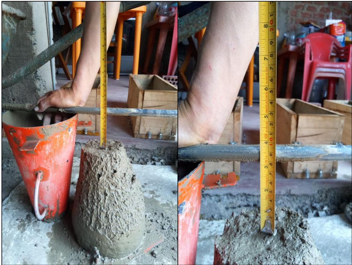
Figura N° 60: Asentamiento del Diseño con 25% de Arcilla Cocida
