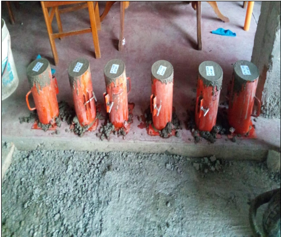
Figura N° 23: Probetas con Adición de Arcilla en 15%
