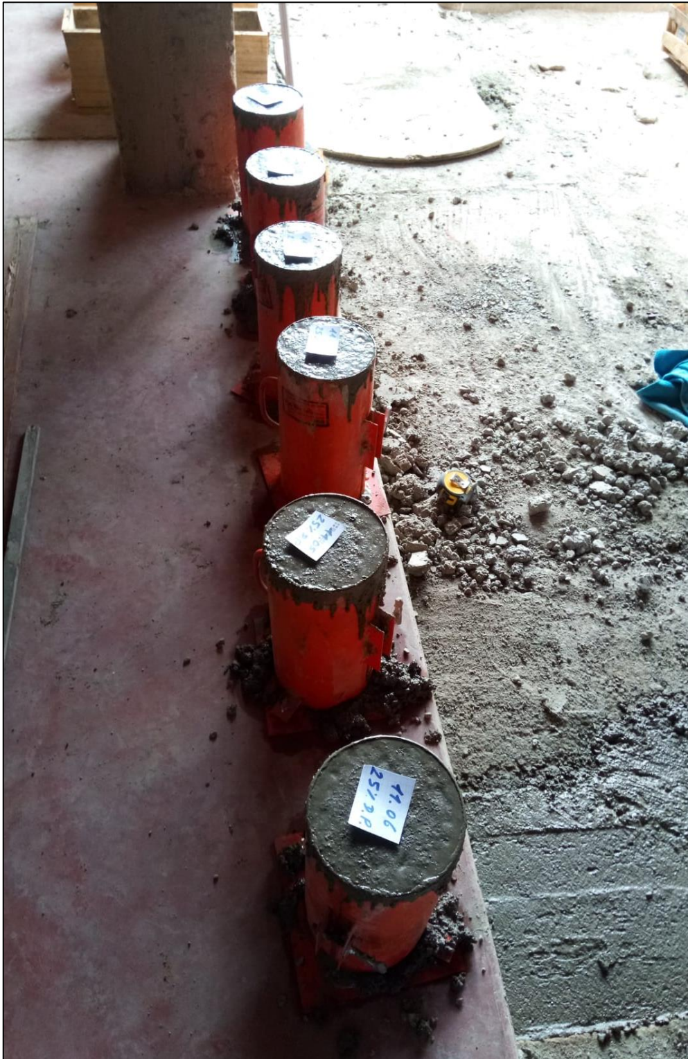
Figura N° 34: Probetas obtenidas de la Mezcla con Adición de Arcilla en 25%
