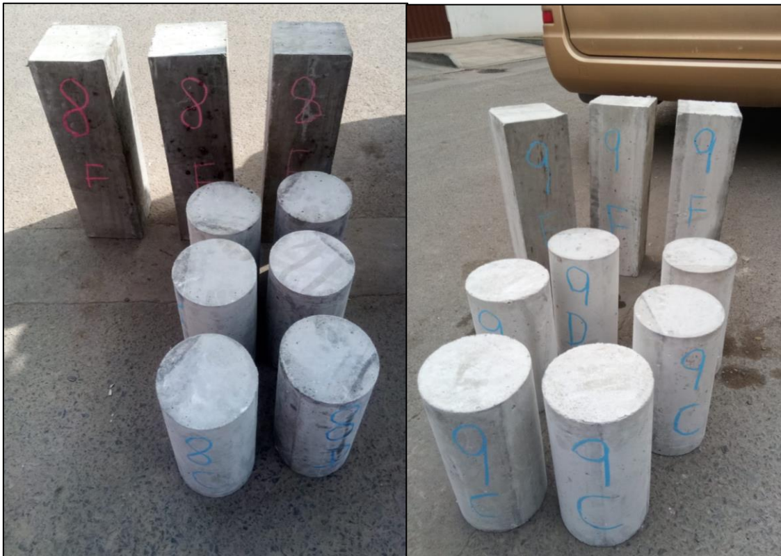
Figura N° 62: Hormigón Endurecido para Rotura a 28 Días
