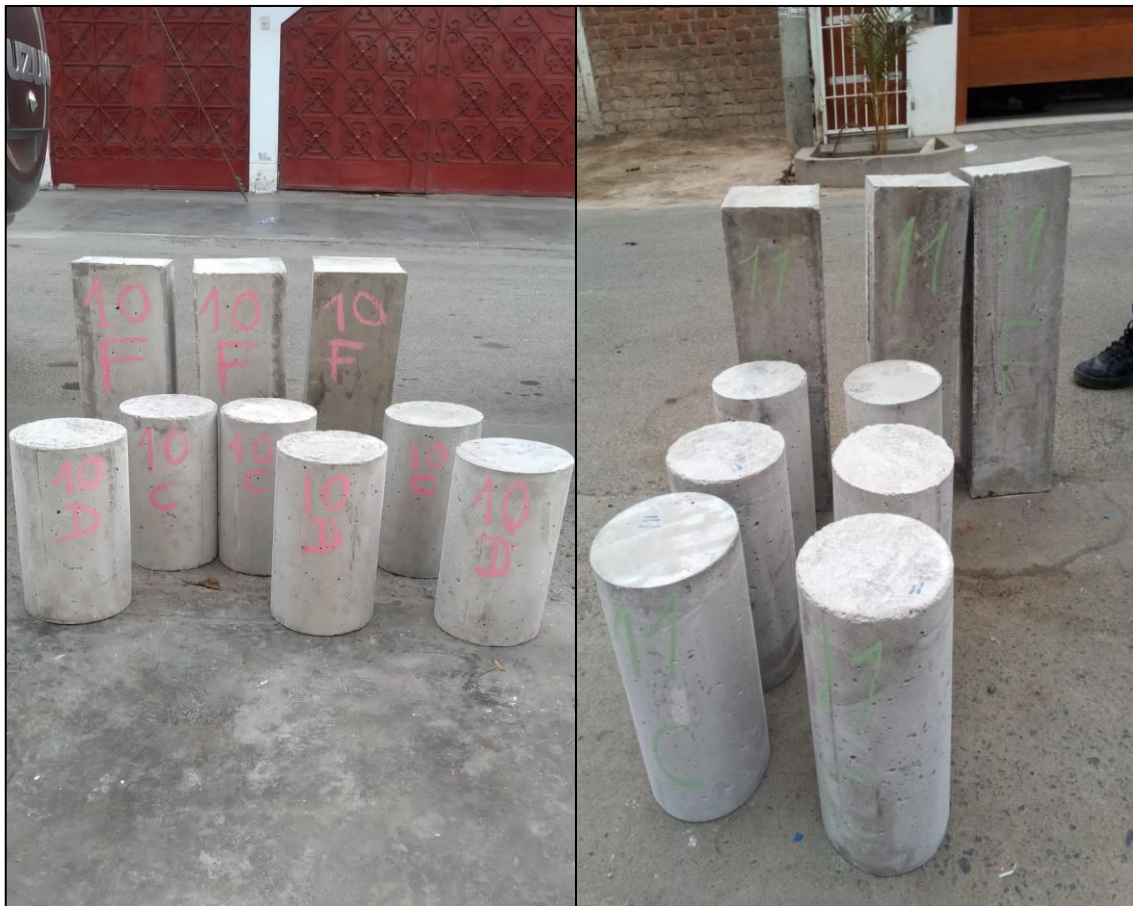
Figura N° 63: Hormigón Endurecido para Roturas a 28 Días
