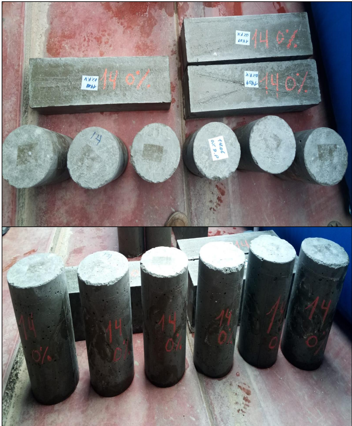
Figura N° 64: Hormigón Endurecido para Rotura a 14 Días
