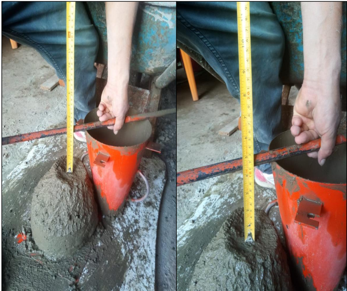
Figura N° 58: Asentamiento del Diseño con 15% de Arcilla Cocida
