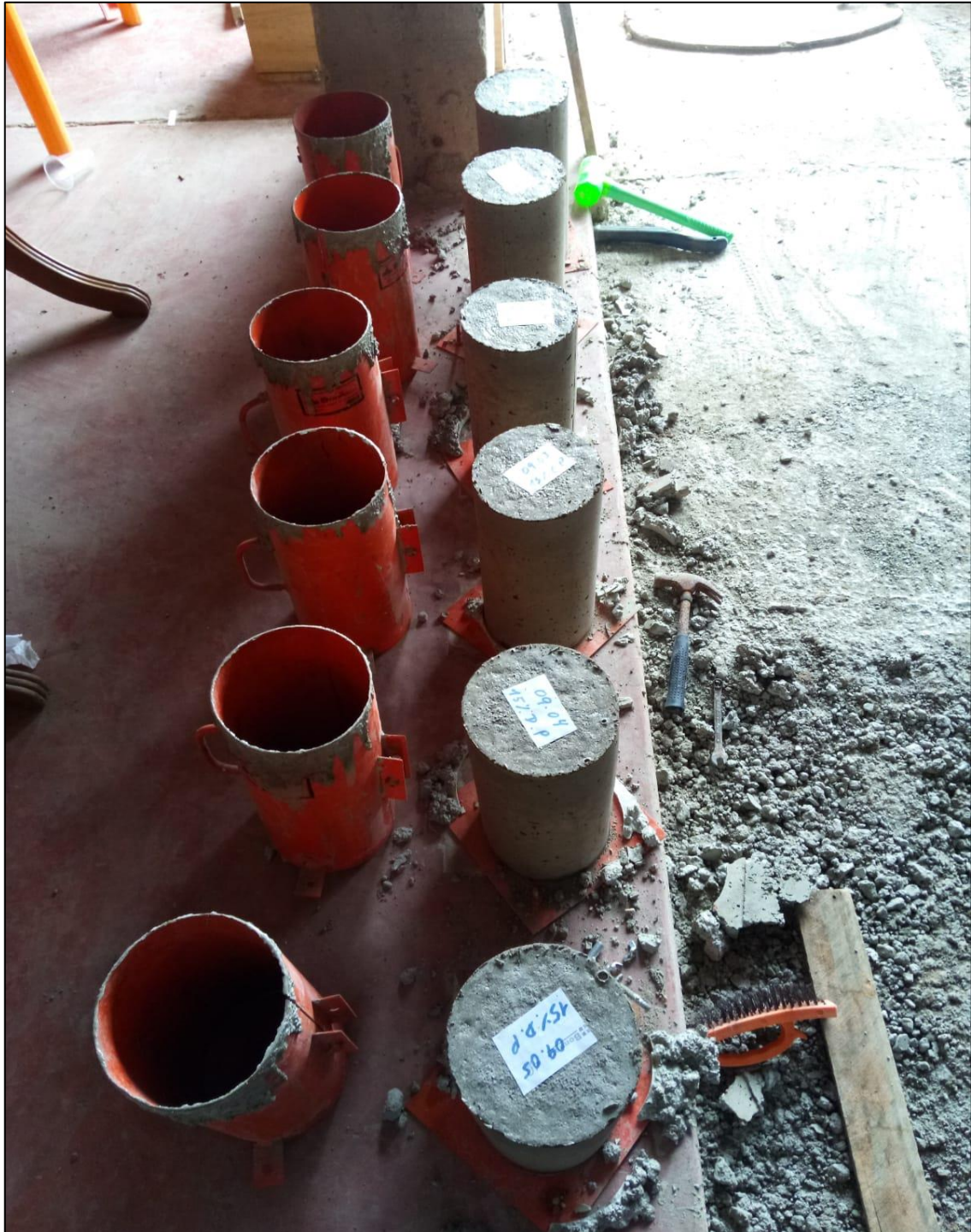
Figura N° 53: Desencofrado de Probetas
