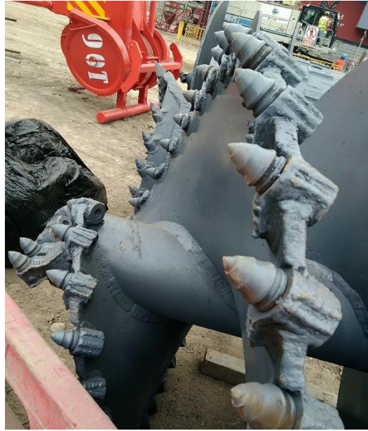
Figura 12: Elementos de corte Fuente: Elaboración propia.
