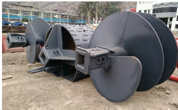
Figura 13: Herramientas de perforación Fuente: Elaboración propia.
