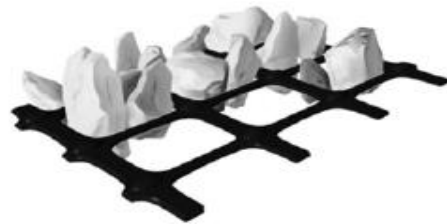
Figura N°15: Geomalla extruida bi-orientada o biaxial
