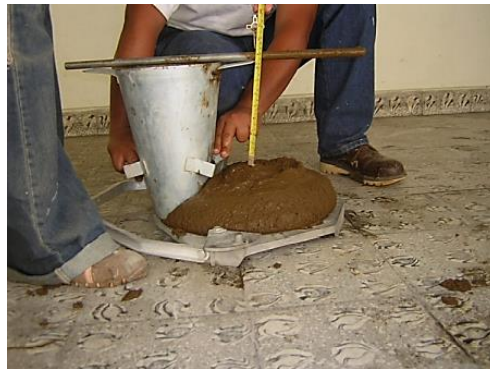
Figura N°32: Medición del revenimiento o slump
