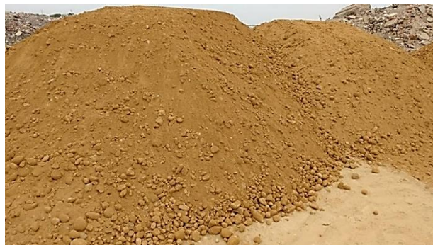
Figura N°8: Muestra de afirmado preparado zarandeado
