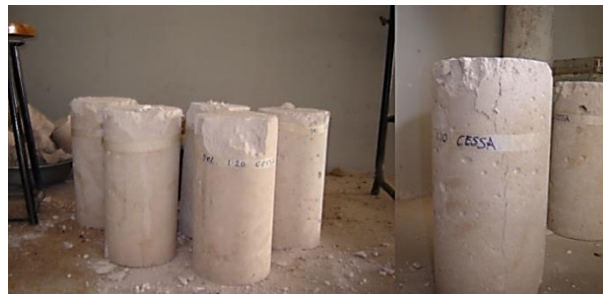
Figura N°33: Fallas de las probetas de relleno fluido
